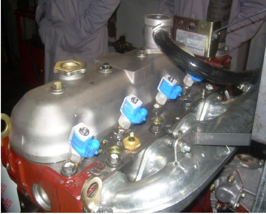
Şekil 4.5: LPG yakıtına dönüşümü tamamlanan dizel motor.
