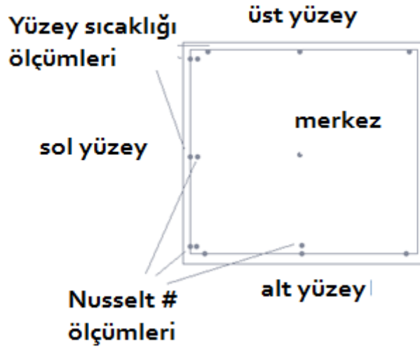
Şekil 4.4 : Deney düzeneği üzerindeki termoeleman yerleşimi.
