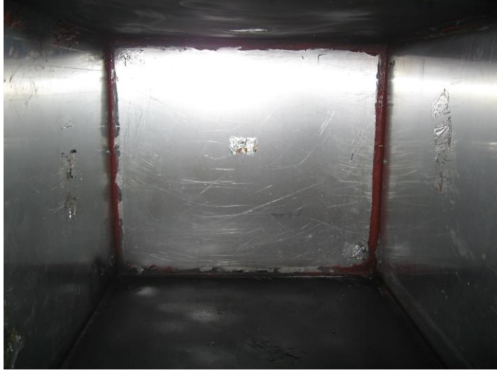
Şekil 3.24 : Alt ve üst yüzeyleri siyah boya ile boyanan deneysel hacim.
