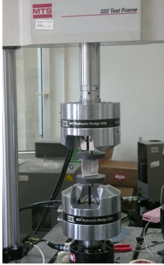
Şekil 4.10 : Basma deneylerinde kullanılan MTS Universal Test Cihazı.
