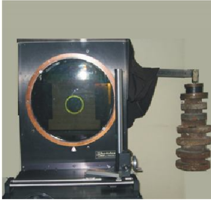
Şekil 3.2 : Gömülü boru modelinin yüklenmesi; a) modelin yükleme şeması, b) polariskopta yüklenmiş modelin genel görüntüsü.
