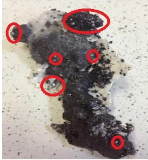
Şekil 5.33 : Karbon iskelet içerisinde kalan kurşun bulyonlar.
