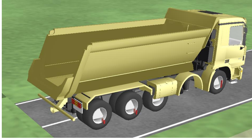
Şekil 4.22: Otomatik dingil indirme sistemi TruckMaker simülasyonu.
