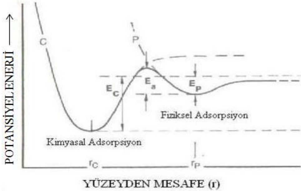
Şekil 4.2 : Fiziksel ve kimyasal adsorpsiyonun mesafeye ve atomlararası etkileşim potansiyeline bağlı değişimi [31].
