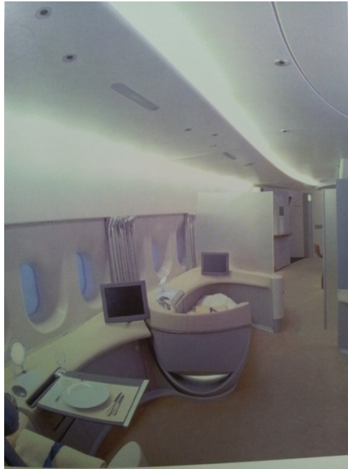
Şekil 2.7: A 380 kabin içi endirekt aydınlatma örneği (Aircraft Interiors, 2005).
