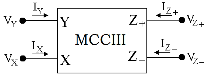
Şekil 2.10 : Değiştirilmiş üçüncü kuşak akım taşıyıcı blok gösterimi.
