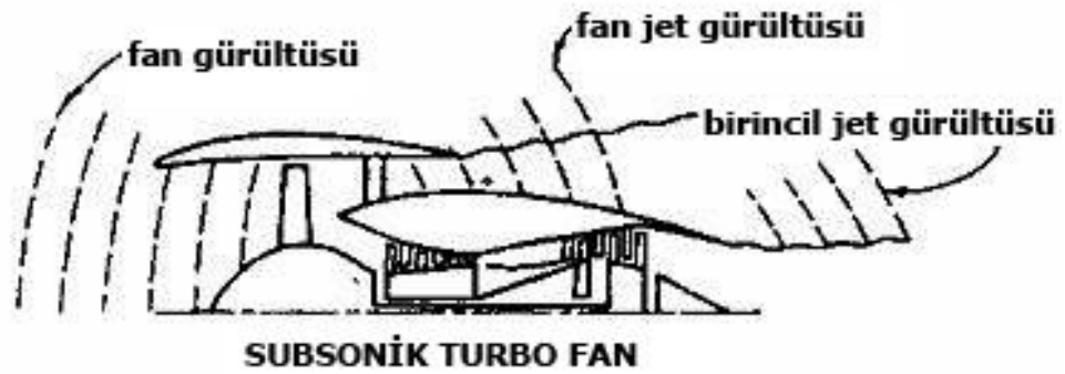
Şekil 2.4 : Şematik turbo fan motoru gürültü kaynakları (URL, 2)
