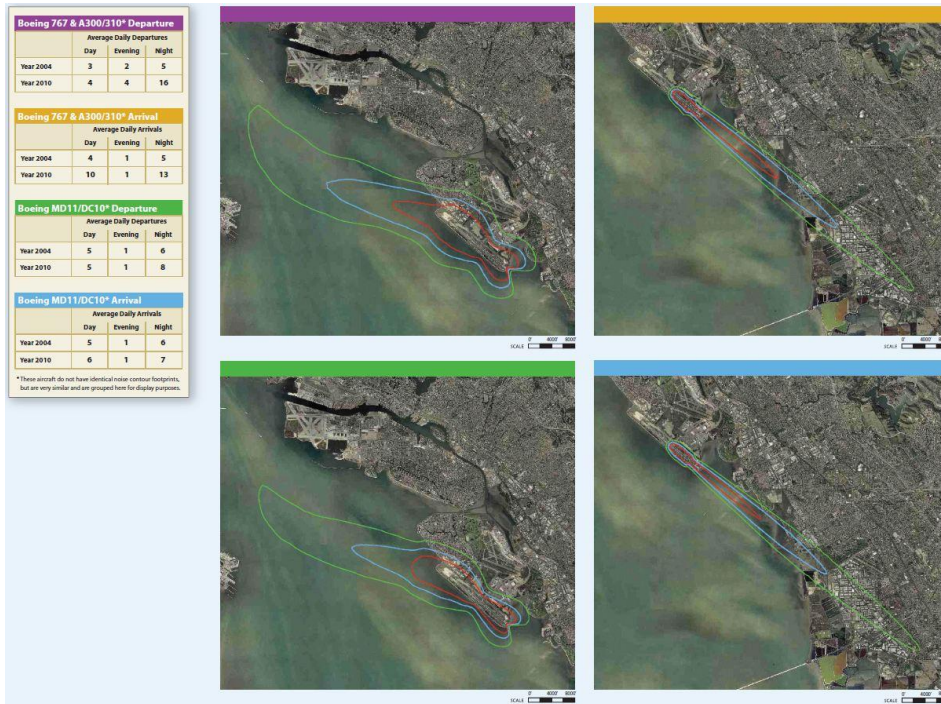
Şekil 4.40 : Tek bir olay için gürültü konturları; Boeing 767 ve Airbus 320 ailesi geniş gövdeli çift motorlu uçaklar için (Oakland Havalimanı, 2006)
