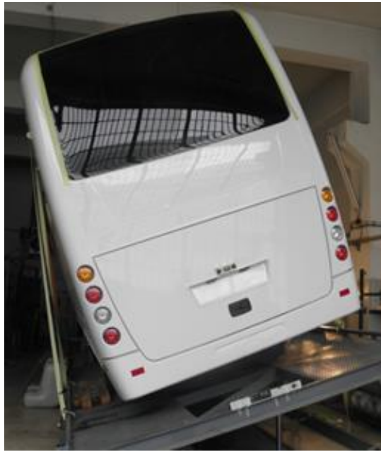
Şekil 5.2 : Zırhlı araç devrilme masası testi.
