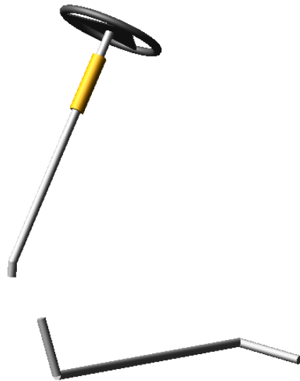
Şekil 3.6 : Direksiyon sistemi Adams/Car modeli.
