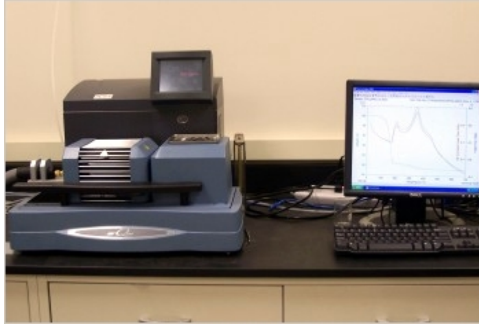
Şekil 3.11 : DTA analiz cihazı.
