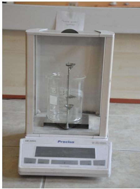
Şekil 3.10 : Hassas terazi ve Arşimet düzeneği.
