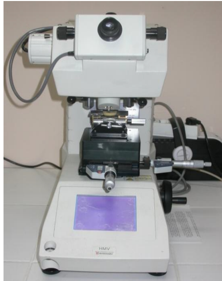
Şekil 3.16 : Vickers mikrosertlik ölçüm cihazı.
