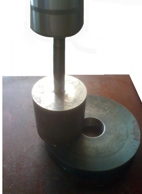
Şekil 3.8 : Hazırlanan peletlerin preslenmesi.
