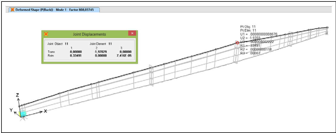
Şekil 5.32 : P(Buck) yüklemesi sonucu şekildeğiştirmiş sistem görünüşü.
