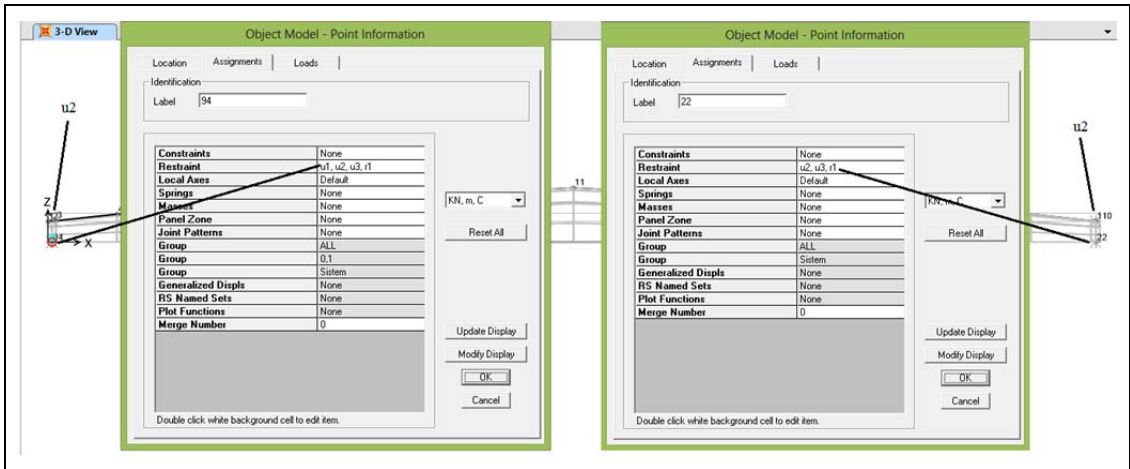
Şekil 5.79 : Model 1a, 2a, 3a ve 4a mesnetlenme şekilleri.
