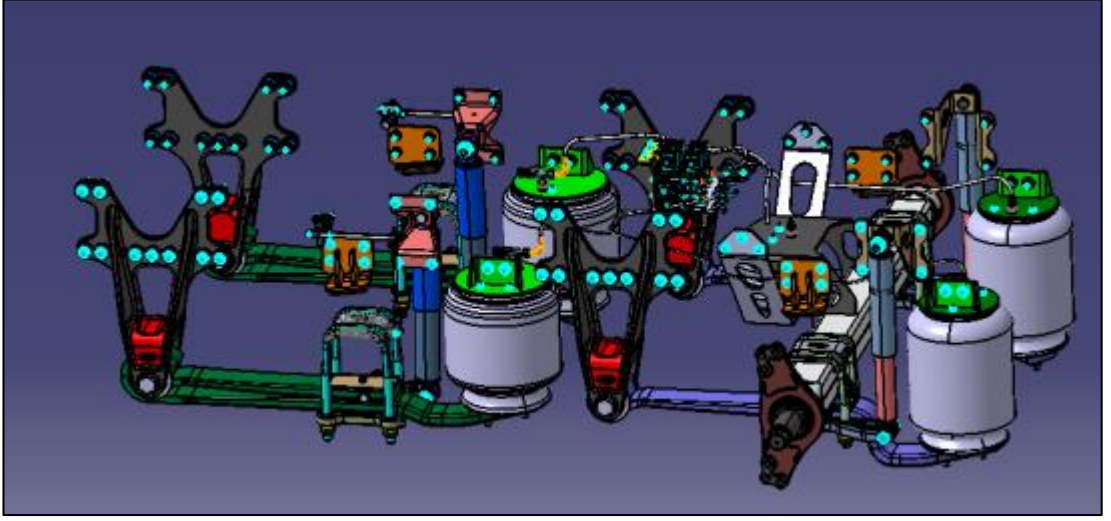
Şekil 2.6 : Havalı süspansiyon makaslarının kullanıldıđı süspansiyon sistemi örneđi.
