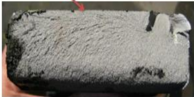
Şekil 6.3 : Tek katlı Z-Tipi makas kırılma örneği.
