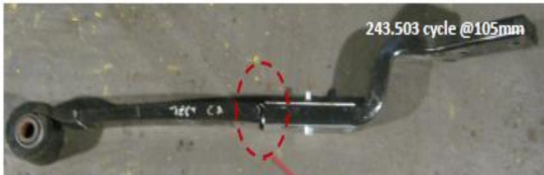
Şekil 6.2 :Çift katlı Z-Tipi makas kırılma örneği.
