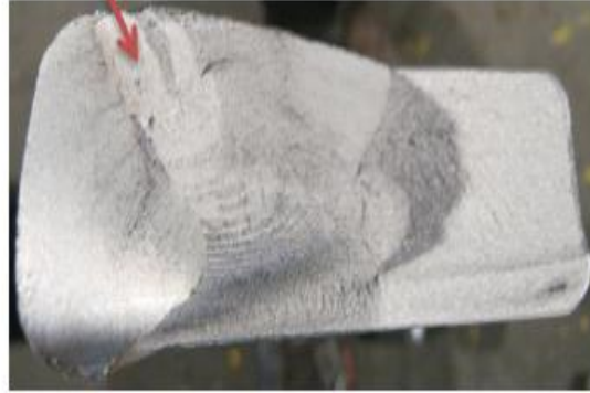
Şekil 6.2 :Çift katlı Z-Tipi makas kırılma örneği.
