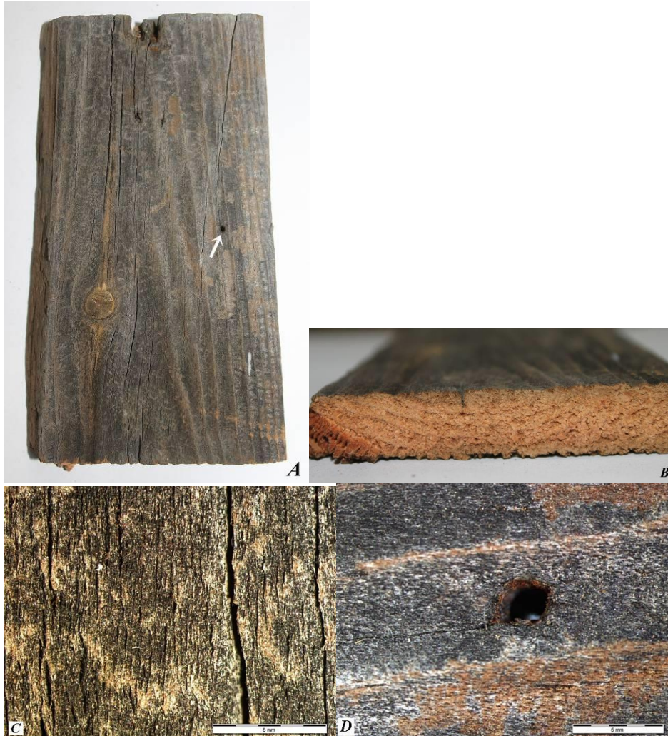
Şekil C.1. 1 Numaralı örneğin makroskopik görüntüleri; A, B, C- Hava koşullarının ağaç malzeme yüzeyinde meydana getirdiği derin çatlaklar, yüzey erozyonu ve renklenmeler (ok ile gösterimde böcek delikleri), A, D- Böceklerin açmış olduğu delikler
