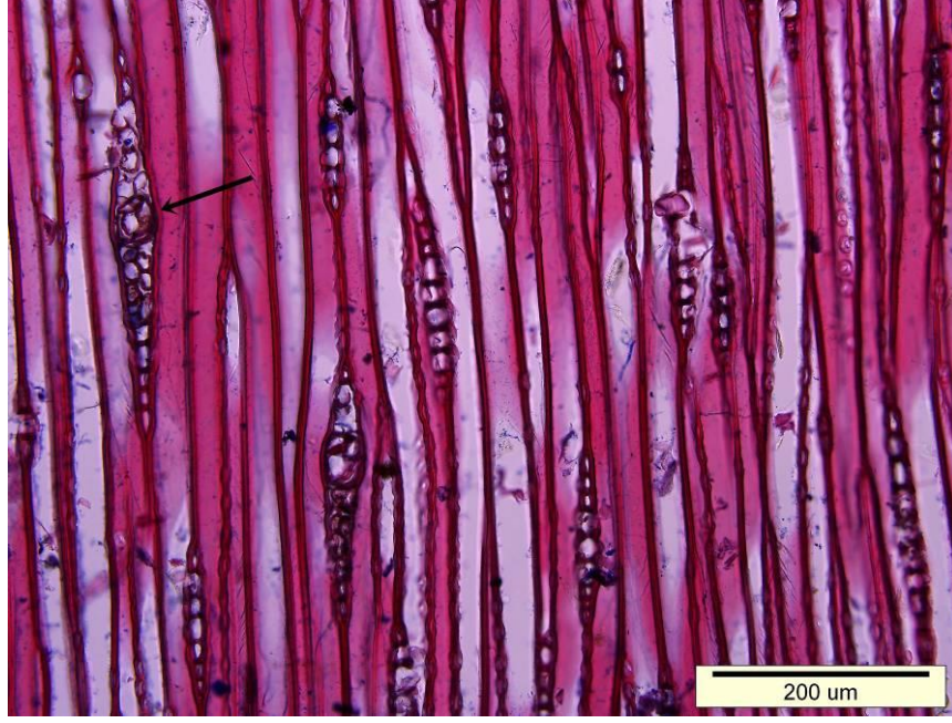
Şekil B.1.3. 1 numaralı örnek teğet kesiti (enine reçine kanalları bulunmakta(ok), öz ışınları çoğunlukla 1-12 hücre yüksekliğinde)
