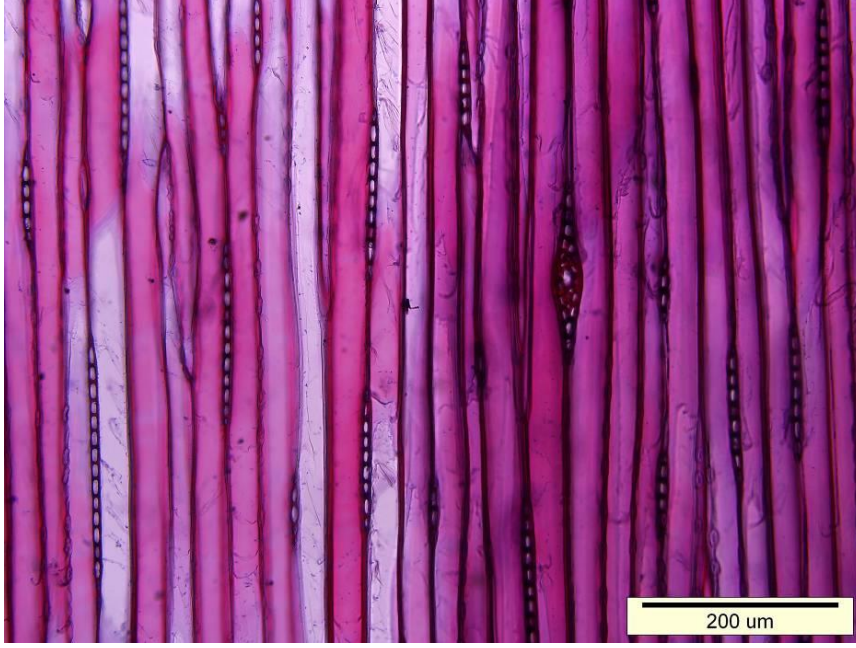
Şekil B.3.3. 3 numaralı örnek teğet kesiti (enine reçine kanalları bulunmakta, enine reçine kanallarını çevreleyen epitel hücreleri 7-9 adet, öz ışınları çoğunlukla 3-11 hücre yüksekliğinde)
