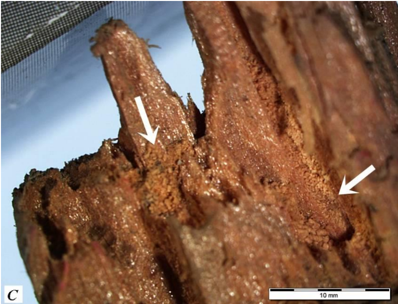
Şekil C.7. 4 Numaralı örneğin makroskopik görüntüleri; A- Genel görünüş, B-C Böceklerin açmış olduğu galeriler, odun öğüntüleri (oklar).
