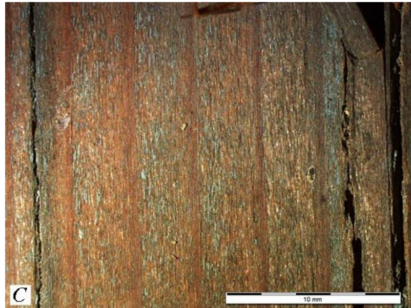
Şekil C.5. 3 Numaralı örneğin makroskopik görüntüleri; A- Genel görünüş, B- Böceklerin açmış olduğu galeriler ve odun öğüntüleri (oklar), C- Yüzeylerde meydana gelen renklenme ve çatlaklar
