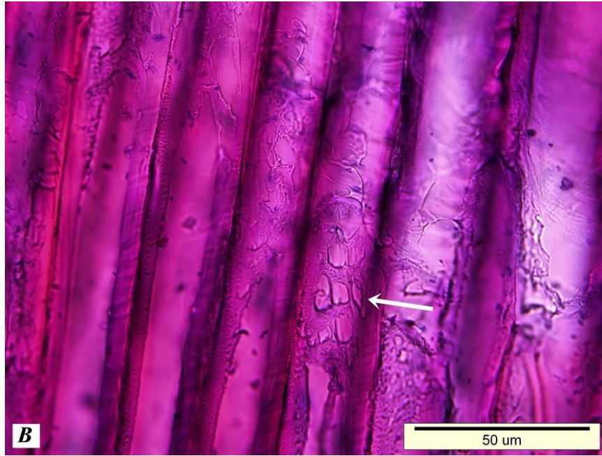
Şekil C.4. 2 Numaralı örneğin mikroskopik görüntüleri; A- Mantar hüfleri (ok), B- Traheid çeperlerinde meydana gelen tahribat (ok)
