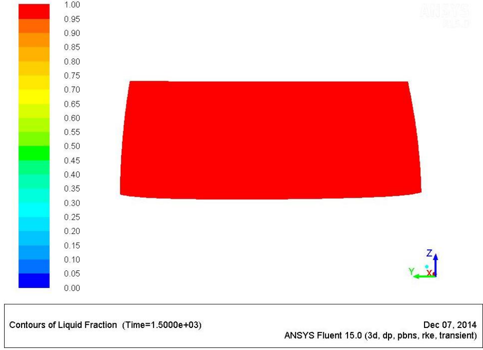
Şekil 6.62 : Adyabatik şart için 25. dakikada çözülmüş buz miktarı.
