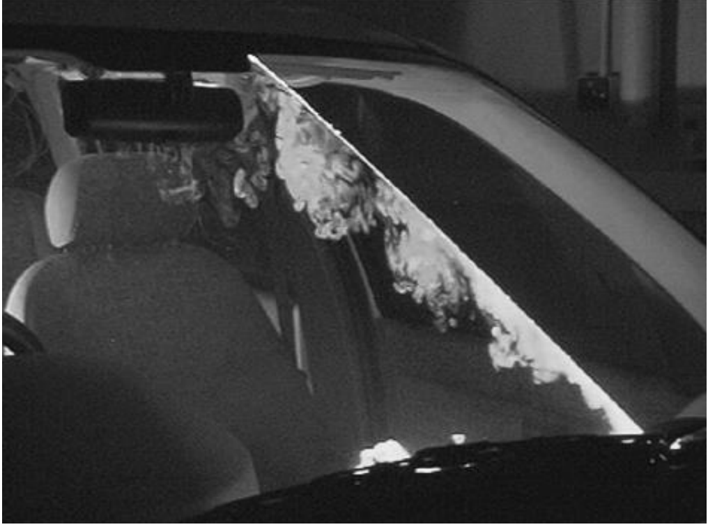
Şekil 2.10 : Ön camı takip eden zayıf hava jetinin örnek görüntüsü [25].
