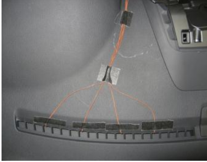
Şekil 5.1 : Ön cam hava üfleci için örnek bir enstrümantasyon.
