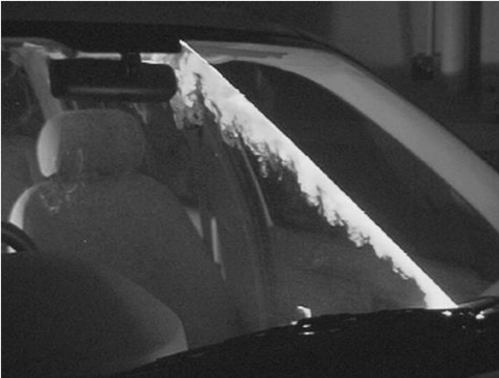
Şekil 2.9 : Ön camı takip eden uygun hava jetinin örnek görüntüsü [25].
