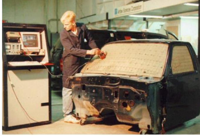
Şekil 5.8 : Ön cam hava hızı ölçüm metodu örnek resim[33].
