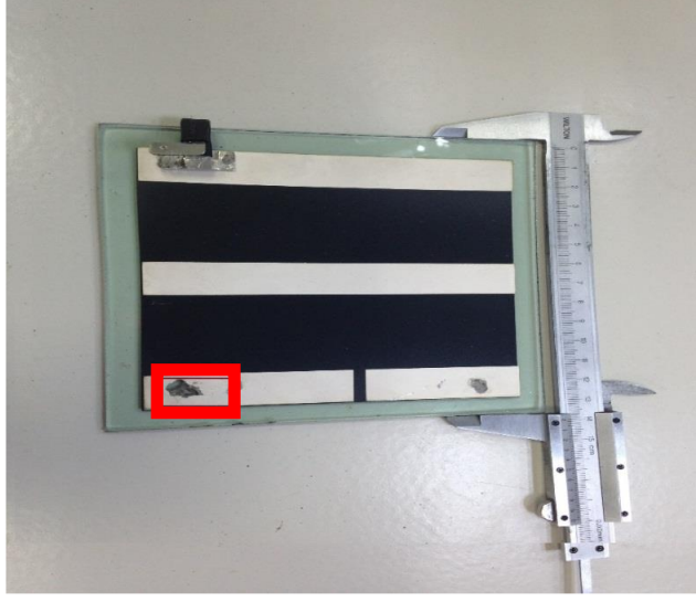
Şekil 6.24: Cam üzerine kalay kaplı bakırların lehimlenmesi.
