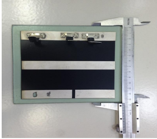
Şekil 6.23: Cam üzerine kalay kaplı bakırların lehimlenmesi.
