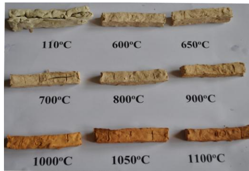
Şekil 6.5: İncelenen Tokat Reşadiye bentonit katkılı seramik bünye tabletlerinin (B1) pişirme sıcaklığına bağlı olarak renk değişimleri.
