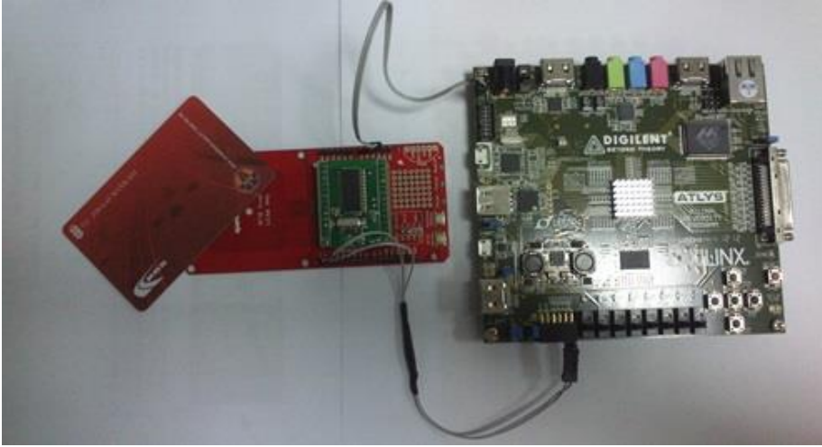
Şekil 5.11 : SM130 modülü ile KGS kartı kimlik bilgisi okunması.
