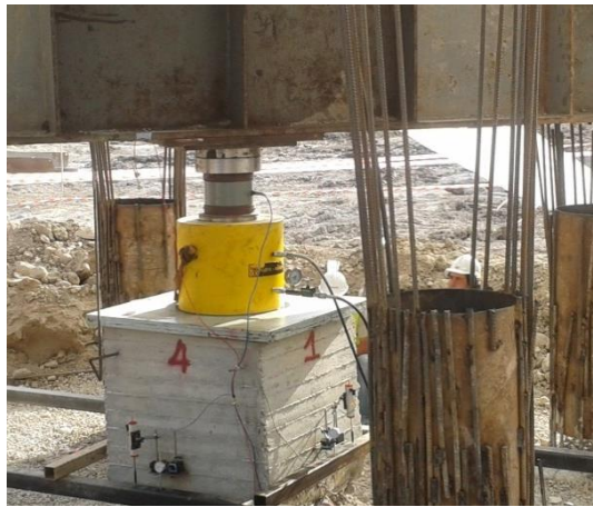
Şekil 6.50 : Hidrolik kriko ve yük hücresi yerleşimi.
