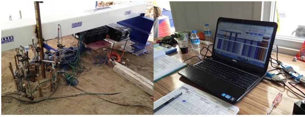
Şekil 4.23 : O-cell test deney düzeneği ve veri alıcı, (Saha - 1, 2013).
