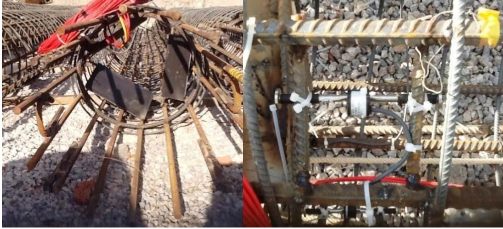
Şekil 6.49 : Gerilme ölçer ve koruma levhası.
