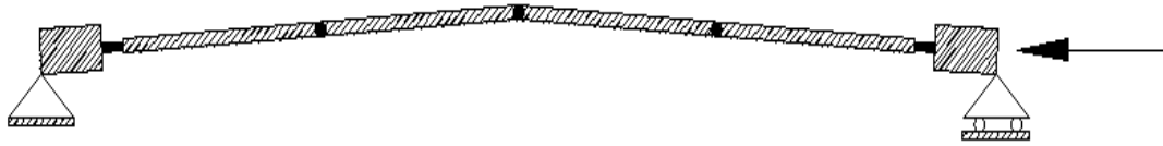
Şekil 4.6 : Bulon ve küre ile tanımlı çubuk eleman modeli.
