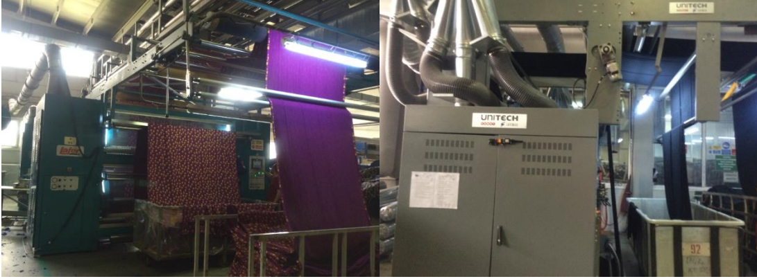
Şekil 3.6 : Şardon ünitesi fotoğrafı.
