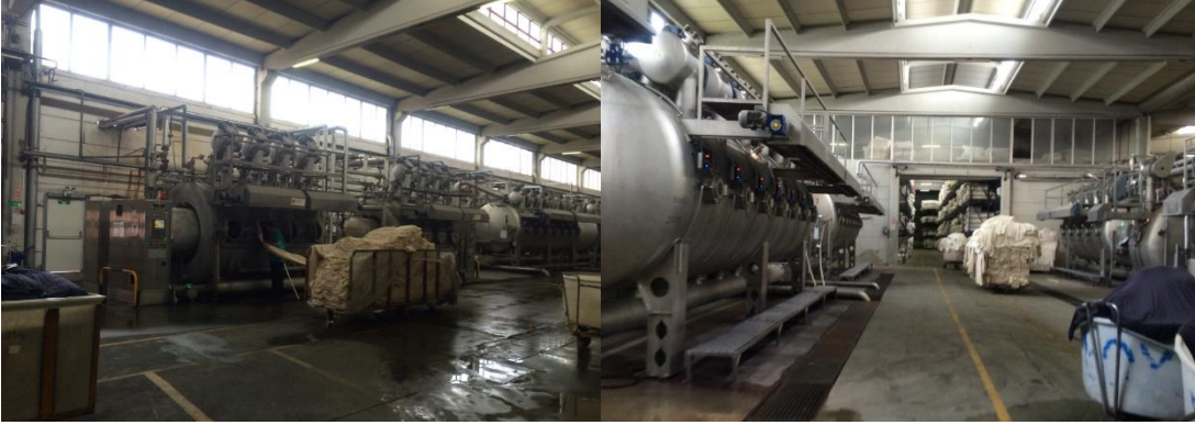
Şekil 3.3 : Kasarlama ünitelerinin fotoğrafı.
