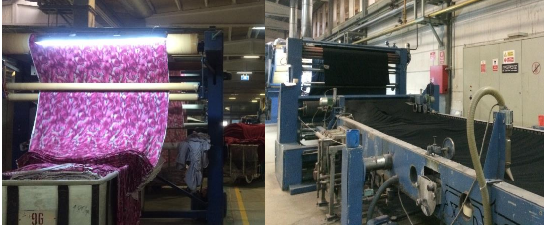
Şekil 3.4 : Pad-Bach ünitelerinin fotoğrafı.
