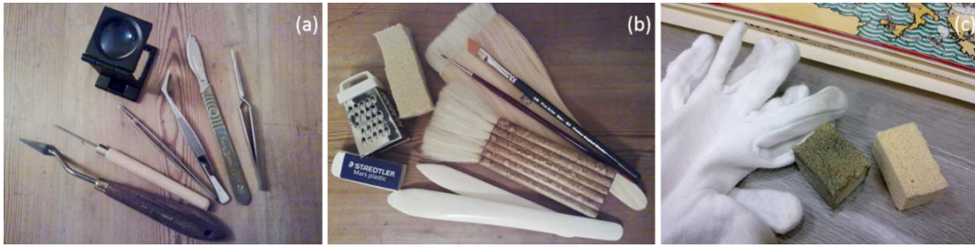
Şekil 2.1 : (a), (b) Mekanik temizlemede kullanılan gereçler (c) Kimyasal süngerle ne kadar kir kaldırılabilirdiğinin bir örneği [37].
