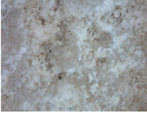
Resim 4.9. M3 kodlu mezar tuğlası kalkerli yüzey mikroskop görüntüsü
