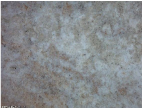
Resim 4.11. M9 kodlu mezar tuğlası kalkerli yüzey mikroskop görüntüsü
