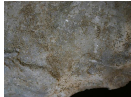
Resim 4.12. L54 kodlu lahit taş yüzeyinde kalkerleşme
