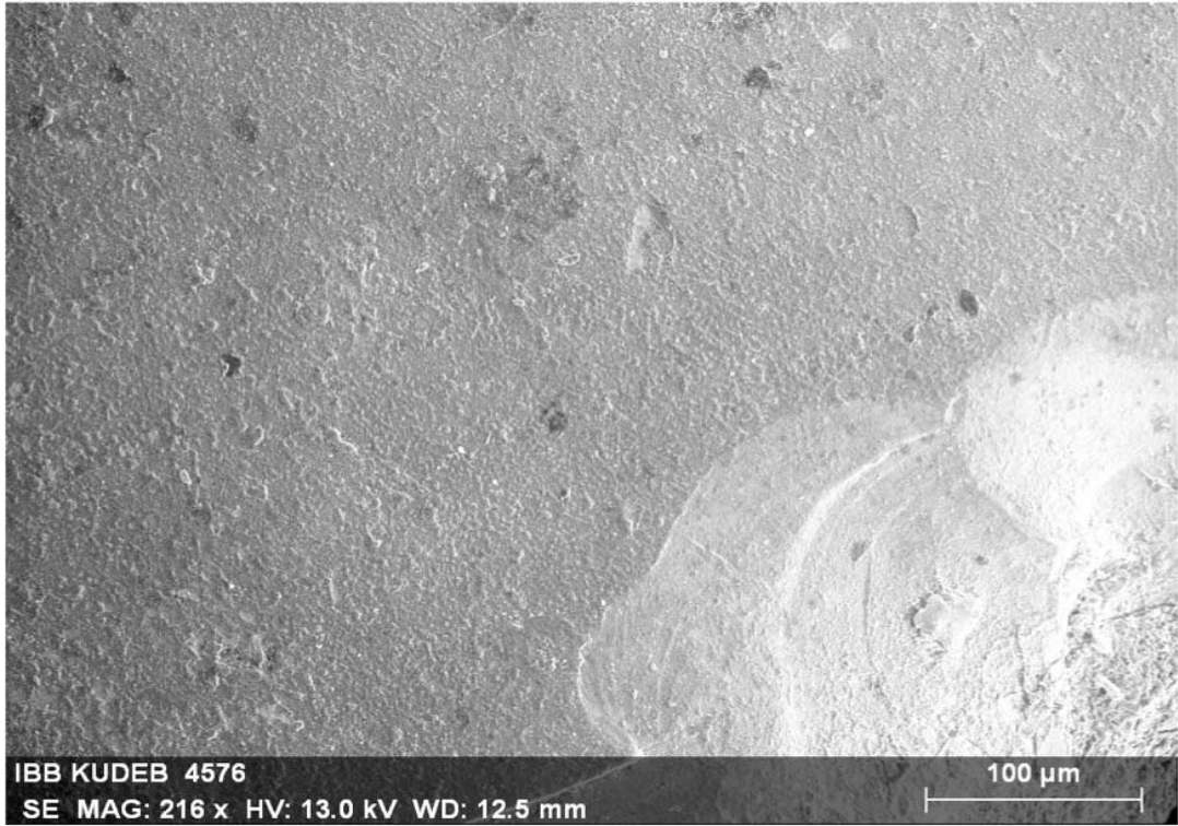
Görüntü 4.3 Örnek-3 Lacivert Renkli Sır Yüzeyinin SEM Görüntüsü, H. Özlem ERSAN, 2013
