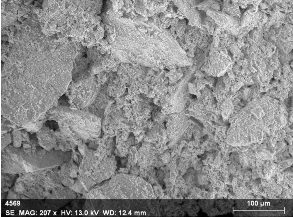
Görüntü 4.5 Örnek-5 Açık Krem Renkli Hamurun SEM Görüntüsü, H. Özlem ERSAN, 2013
