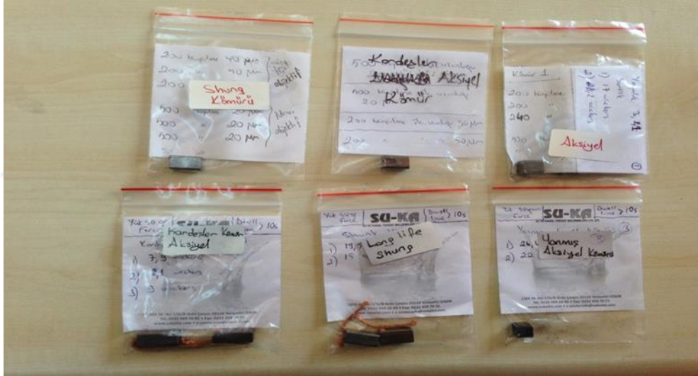
Şekil 3.1: Deneyleerde belirlenen yerli ve ithal numune motor kömürleri
