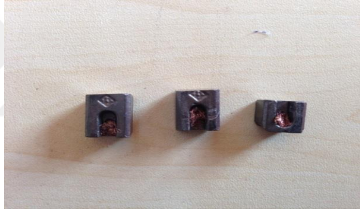
Şekil 3.19: İade motorlardan sökülen ergimiş kömürler
