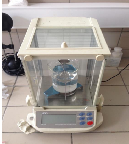
Şekil 3.11: AND GR-200 yoğunluk ölçme cihazı
