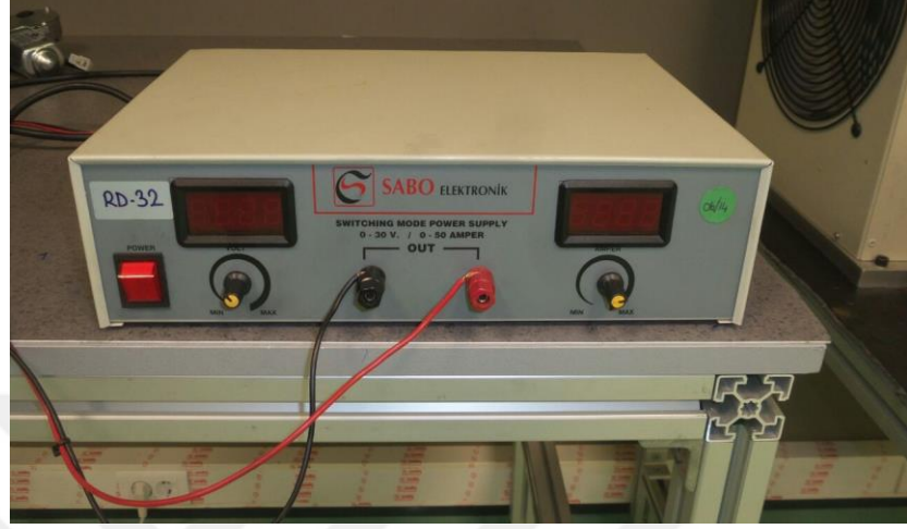
Şekil 3.15: SABO ELEKTRONİK marka redresör cihazı
