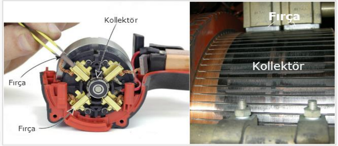
Şekil 2.12: Kollektör ve Fırça Yapısı
