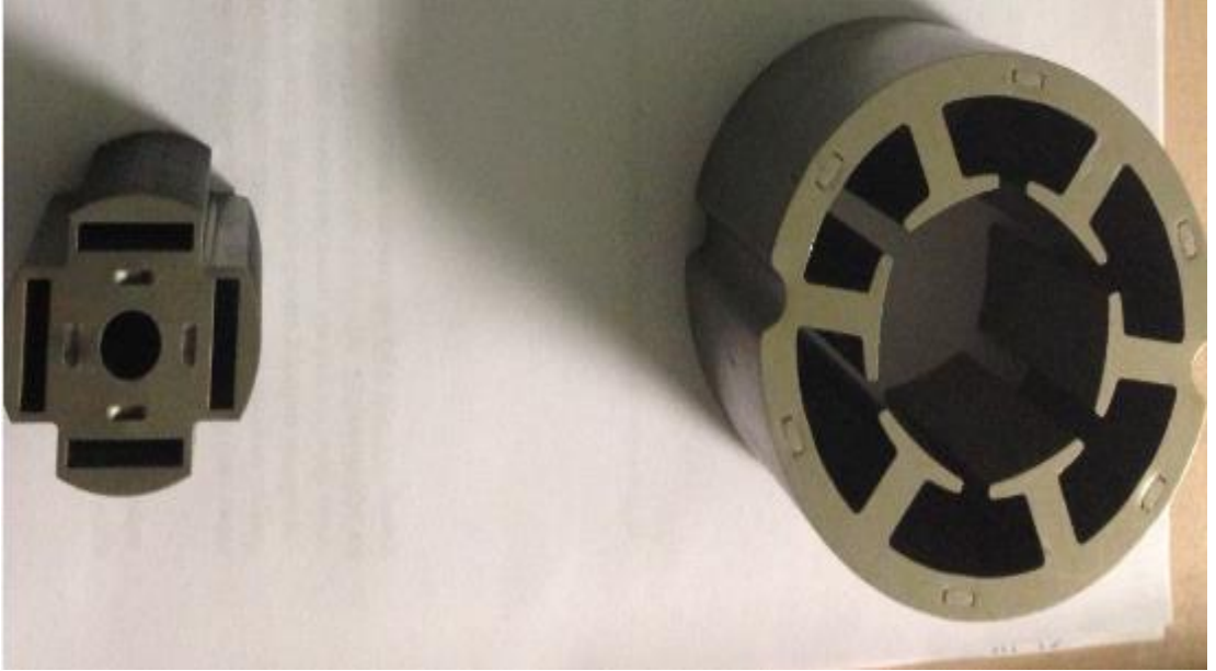
Şekil 2.13: Silisli Sac'tan Yapılmış Rotor ve Stator
