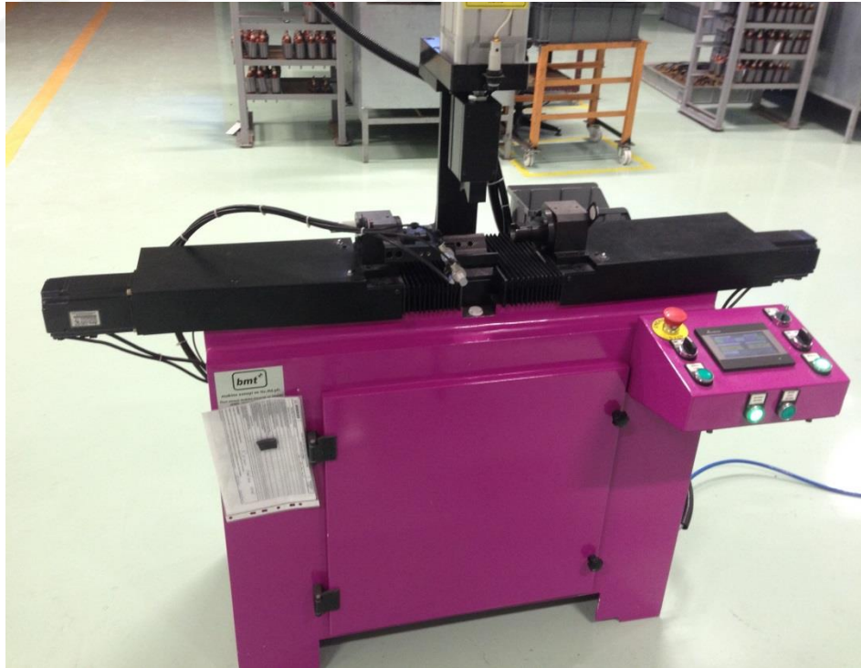
Şekil 3.14: DELTA rulman çakım makinası
