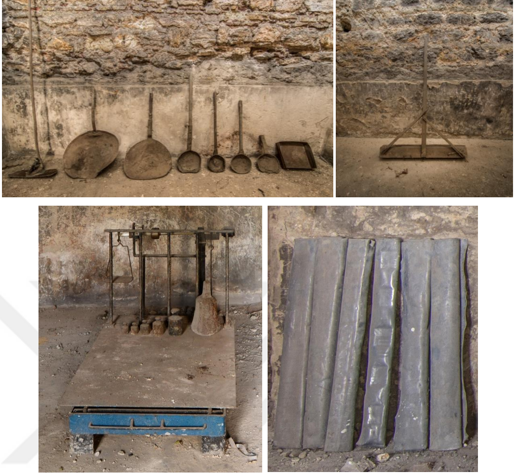
Şekil 2.39. Kurşun üretiminde kullanılan aletler ve endüstriyel rulo kurşunlar
