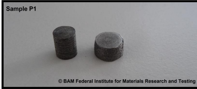
Şekil 4.5 : Soldaki: Deformasyona uğramamış numune (5x6mm), sağdaki: deforme olmuş numune
