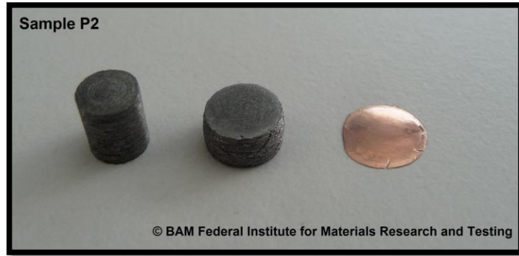
Şekil 4.9 : Soldan sağa: deformasyona uğramamış numune (5x6 mm), deforme numune, bakır vuruş şekillendirici (pulseshaper) 5x0,2 mm)
