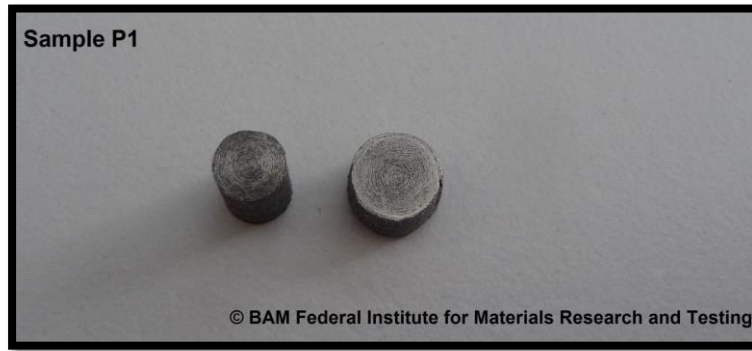
Şekil 4.6 : Soldaki: Deformasyona uğramamış numune (5x6mm), sağdaki: deforme olmuş numune, üst bakış
