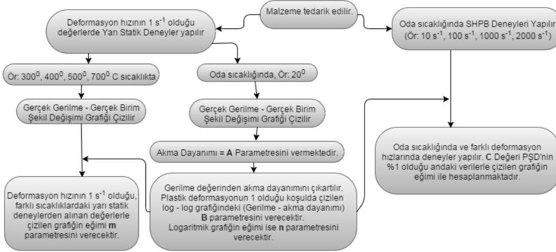
Şekil 4.17 : Vermiküler grafitli dökme demirin JC Parametrelerinin hesaplanması için yapılan işlemlerin akış şeması
