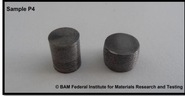
Şekil 4.14 : Soldaki: deformasyona uğramamış numune (7x9 mm), sağdaki deforme numune
