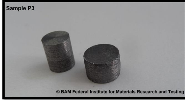
Şekil 4.11 : Soldaki: deformasyona uğramamış numune (7x9 mm), sağdaki deforme numune
