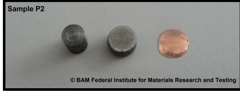
Şekil 4.8 : Soldan sağa: deformasyona uğramamış numune (5x6 mm), deforme numune, bakır vuruş şekillendirici (pulseshaper) 5x0,2mm)
