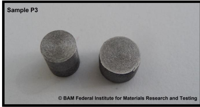
Şekil 4.12 : Soldaki: deformasyona uğramamış numune (7x9 mm), sağdaki deforme numune (üst bakış)
