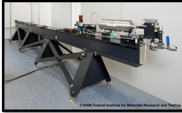
Şekil 4.3 : Split Hopkinson Pressure Bar deney düzeneği, BAM Federal Enstitüsü
