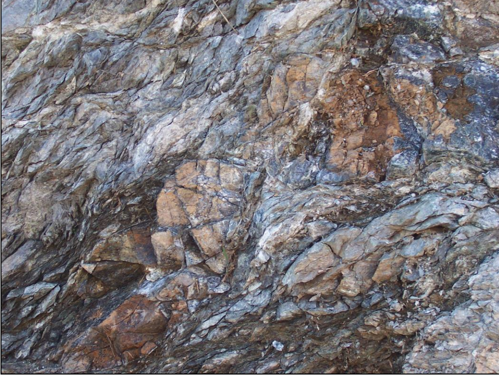
Şekil 3.2 : Tektonik etkiler sonucu yan kayaç ve manyezitlerde oluşan son derece çatlaklı ve parçalanmış ezik zonlar.
