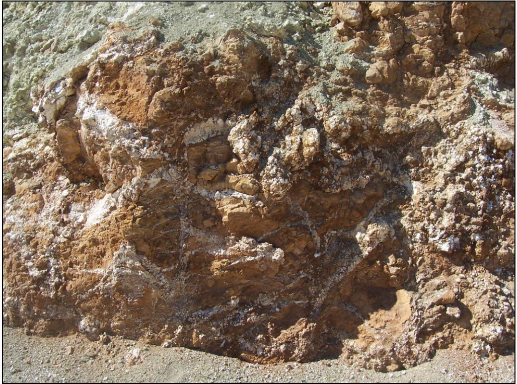
Şekil 3.8 : Birbiri içine geçmiş, birbirini kesen, kıvrımlanmalar ve faylarla ötelenmeler gösteren damar ve ağsal manyezitler.
