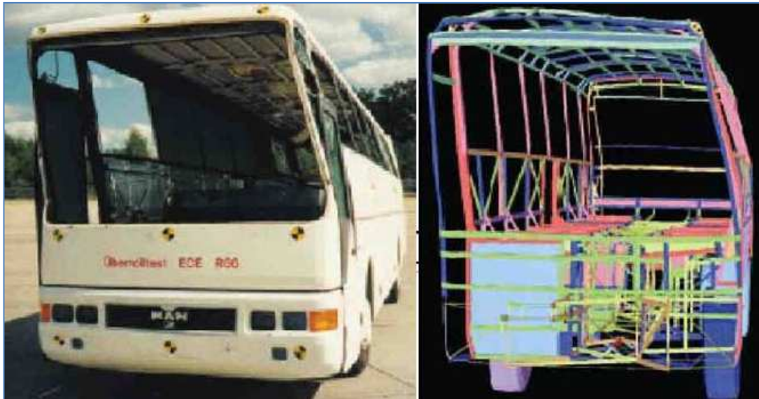
Şekil 1.7 : Devrilme test sonucu ile simülasyon sonucunun karşılaştırılması.
