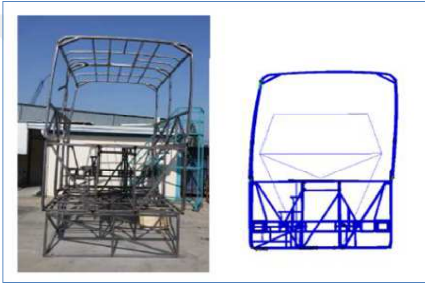
Şekil 4.9 : Kısmi gövdenin analiz ve test sonuçlarının karşılaştırılması.
