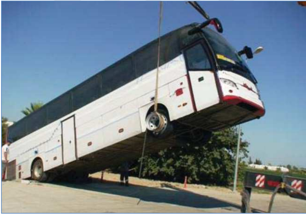
Şekil 5.4 : Gövde açısı ve arka tekerleklerin ağırlıklarının ölçülmesi.
