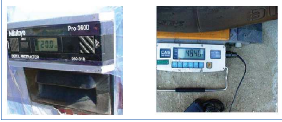
Şekil 5.5 : Aracın gövde açısı ve arka tekerleklerin ağırlıklarının ölçüm sonuçları.
