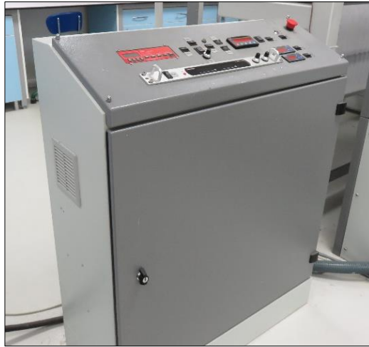
Şekil 2.6 : Yüksek voltaj güç kaynağı.
