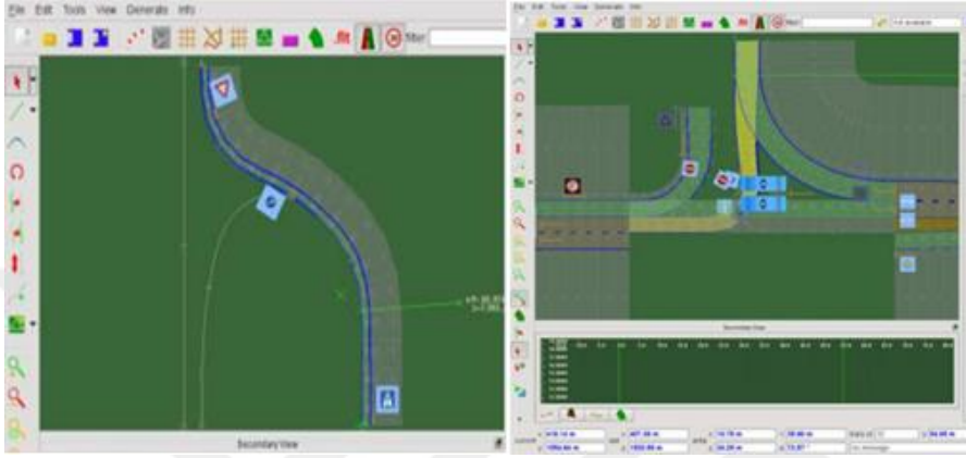
Şekil 4. 13 : ROD yazılımında yol güzergahının ve trafiğin tanımlanması (Url-29).
