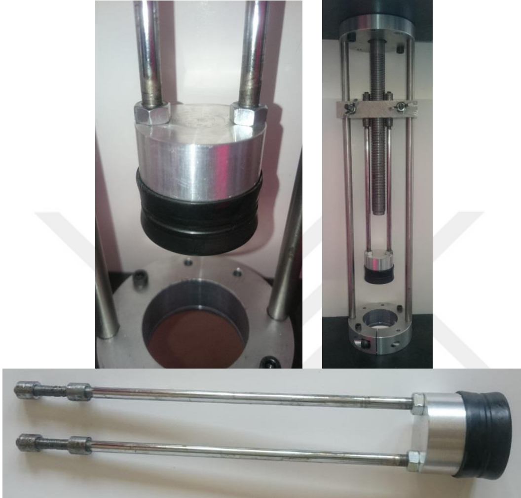
Şekil 4.10 : Piston keçesi ve piston.
