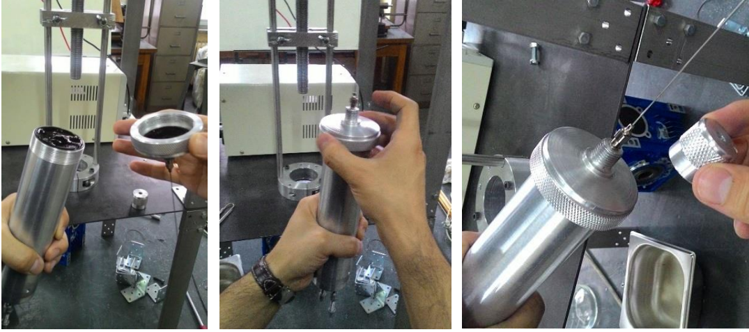
Şekil 5.2 : Grafen haznesinin doldurulması.
