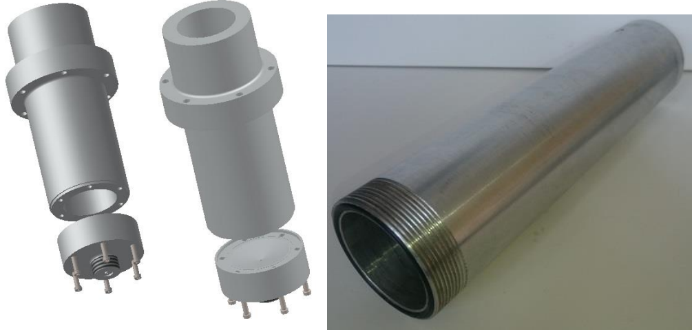
Şekil 4.11 : İlk grafen haznesi tasarımı ve iyileştirilmiş hali.
