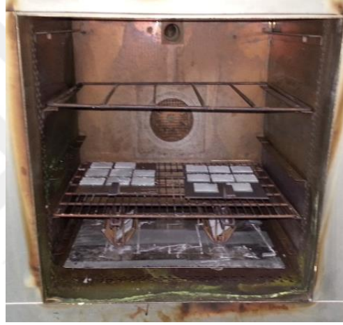
Şekil 3.7 : Fırına şarj edilen tuz pastası kaplı cam numuneler.
