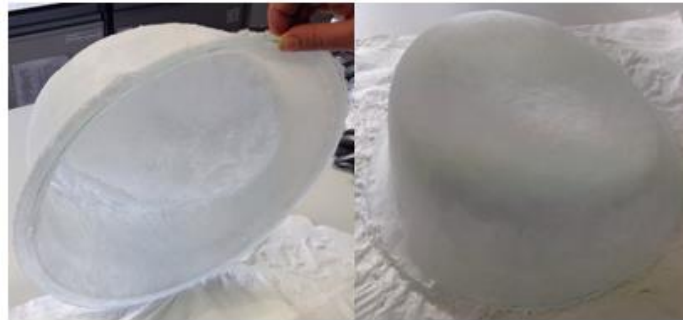
Şekil 6.2 : Cam kapakların tuz pastasıyla kaplanması.
