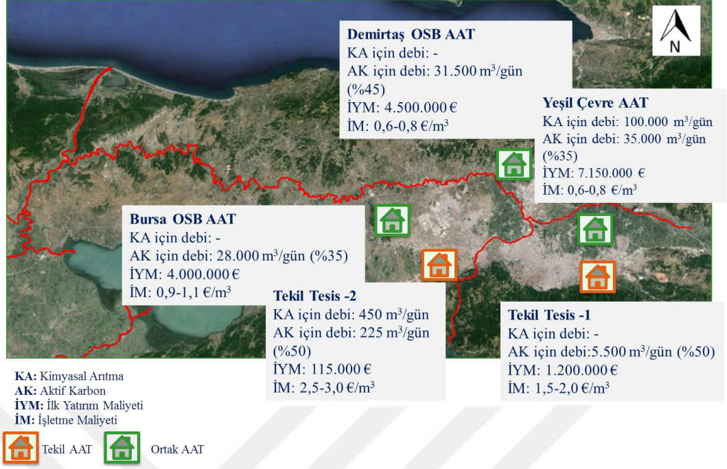
Şekil 4.7 : Nilüfer Çayı Alt Havzası'ndaki 13.30 NACE kodlu alt sektörden kaynaklı tehlikeli madde kontrolüne ilişkin maliyet tahmini özeti.
