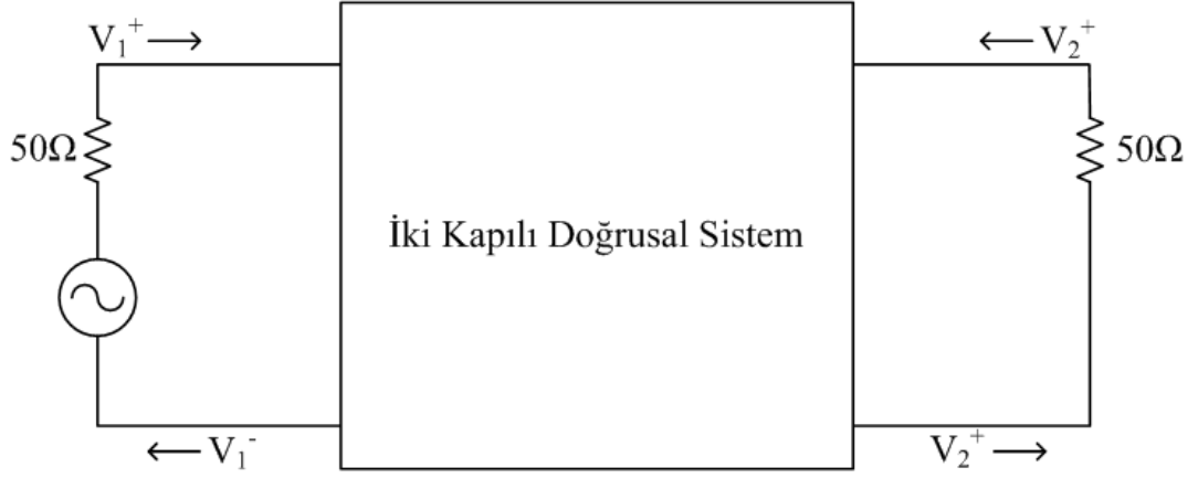
Şekil 1.1 : Gelen ve yansıyan dalgaların iki kapılı sistemde gösterimi.
