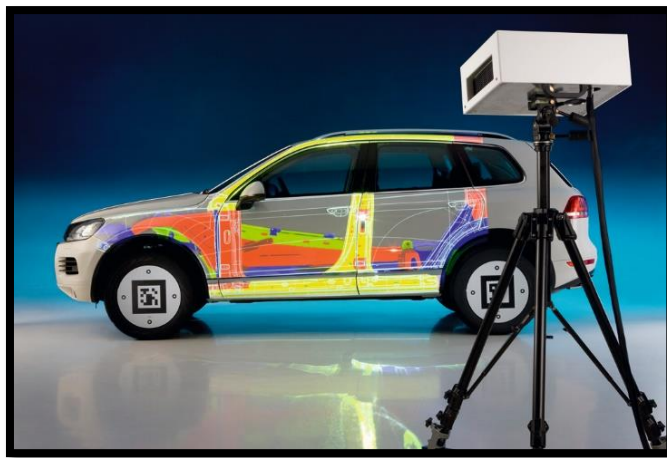
Şekil 3.4 : VW Toureg yapı iskeletinin araç üzerine yansıtılması.
