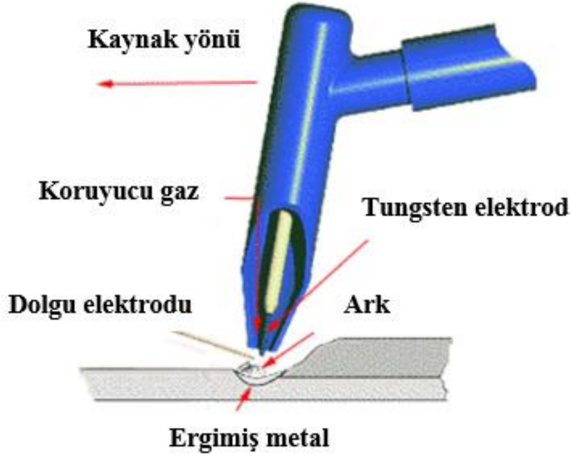
Şekil 3.4 : TIG kaynağı şematik gösterimi [33].
