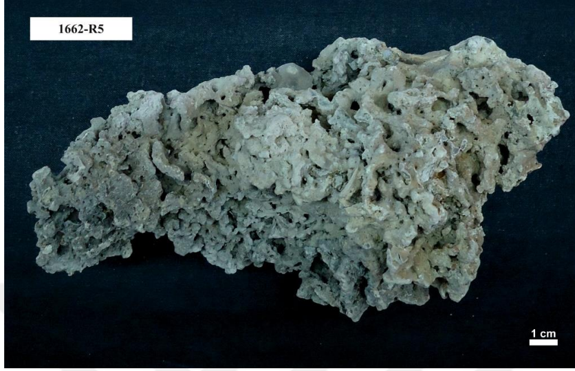
Şekil 4.12: Boşluklu ve böbreğimsi, pürüzlü yapıdaki 1662-R5 no'lu örneğin görünümü. Örnek üzerindeki boşluklar 1662-R4 no'lu örnekten daha küçüktür (Şekil 4.11A).
