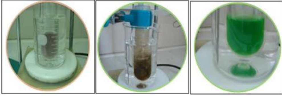
Şekil 4.2 : (a) Homojenizasyon (b) Solüsyon içinde çözülmüş gazın yapıdan uzaklaştırılma işlemi gerçekleştirilmesi (13 saat) (c) Canlı PMMA (17saat) (Bel ve diğ., 2014)
