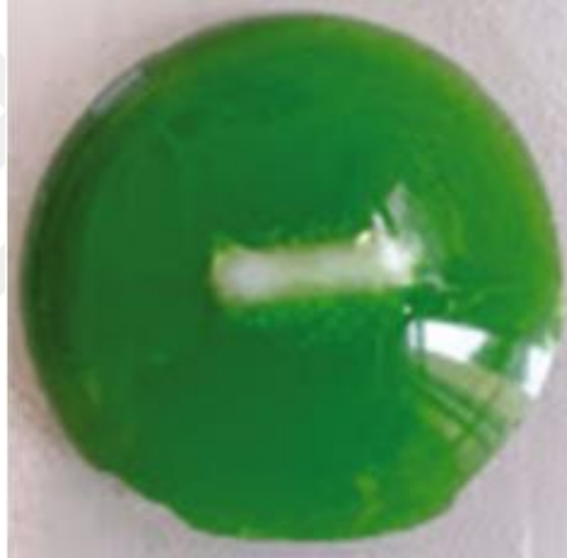
Şekil 4.3 : ATRP yöntemi ile üretilen canlı polimer PMMA (Bel ve diğ., 2014).
