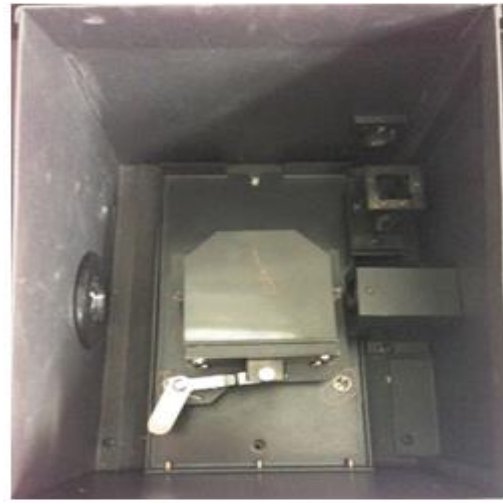
Şekil 4.9 : Optik ölçümlerin yapıldığı spektrofotometrenin (a) geçirgenlik (b) yansıtıcılık ölçüm alanları.
