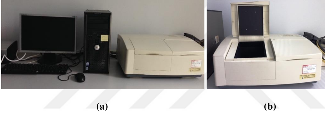
Şekil 4.8 : (a) Optik ölçüm sistemi (b) ölçüm yapılan UV- VIS spektrofotometre.
