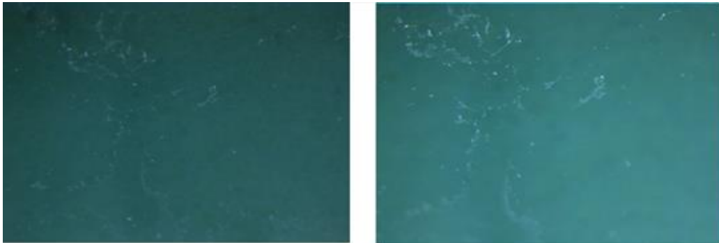
Şekil 5.3 : Degas edilmiş PMMA polimer yapının optik mikroskop görüntüleri.
