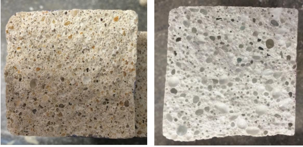
Şekil 5.9 : Kum ve cam agregalı numune kesitleri.
