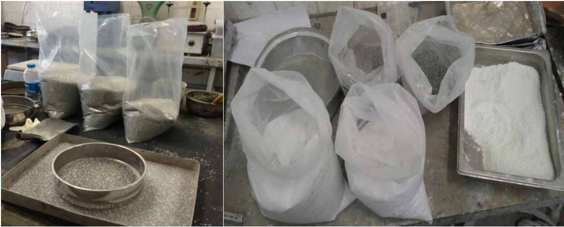
Şekil 4.1 : Cam agregaların çeşitli elek boyutlarından elenerek gruplanması.
