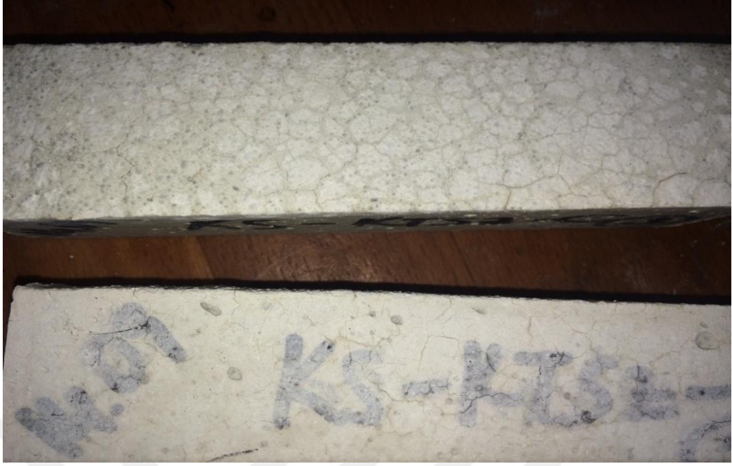
Şekil 5.8 : Deney sonrası ASR'ye uğrayan numune fotoğrafları (HHCD).
