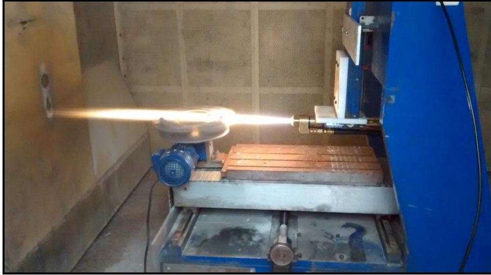
Şekil 4.13 : Bağ katman kaplamaların üretim işlemi.
