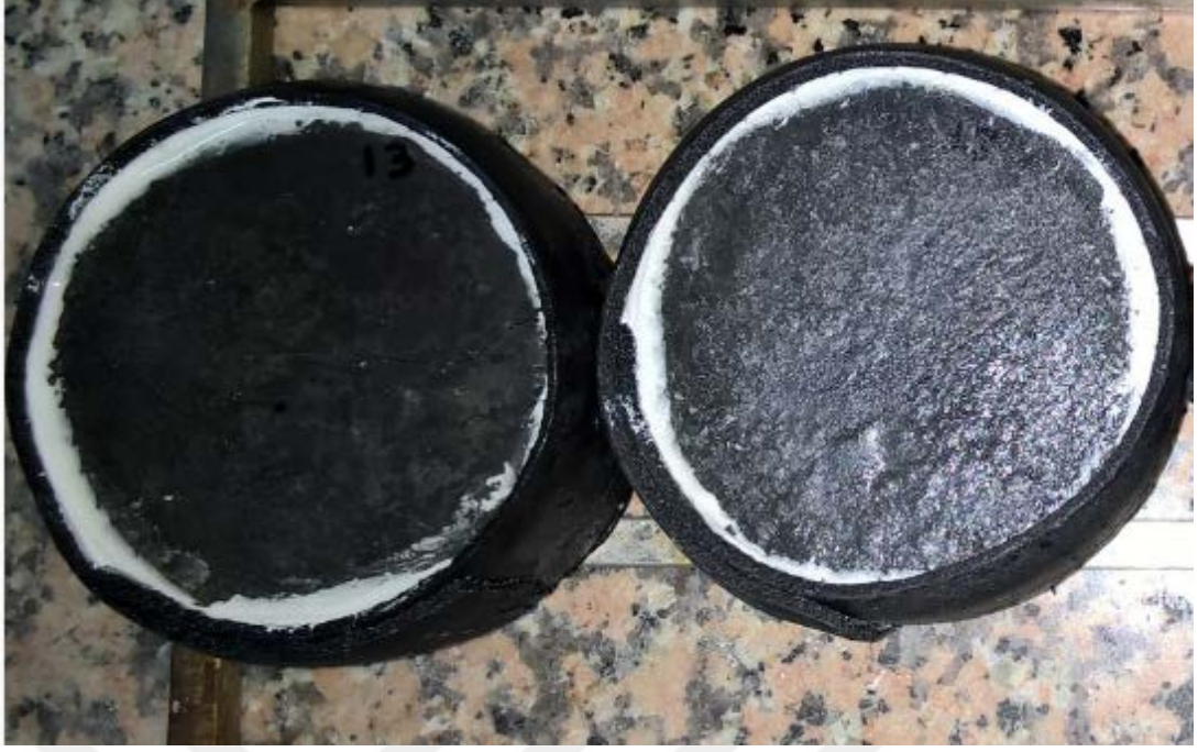
Şekil 4.50 : TM uygulanmayan ultra yüksek dayanımlı beton numunelerin donma çözülme çevrimleri sonrası görüntüsü.
