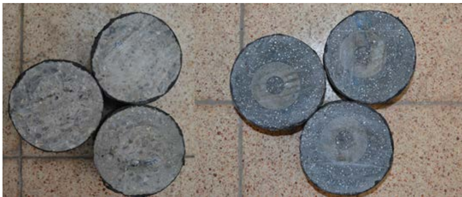
Şekil 4.26 : Betondan paspayı kullanılan normal (solda) ve ultra yüksek dayanımlı betonda (sağda) etüv kurusu numuneler.
