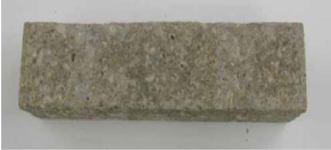
Şekil 2.13 : 95 hafta 6,04 molar NaCl çözeltisine maruz bırakılan numuneler [85].
