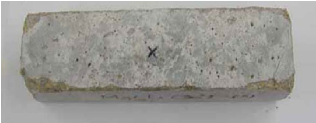
Şekil 2.12 : 80 hafta 1,06 molar MgCl 2 çözeltisine maruz bırakılan numuneler [85].
