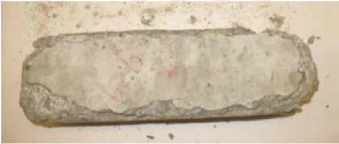
Şekil 2.14 : 10 hafta 6,04 molar MgCl 2 çözeltisine maruz bırakılan numuneler [85].
