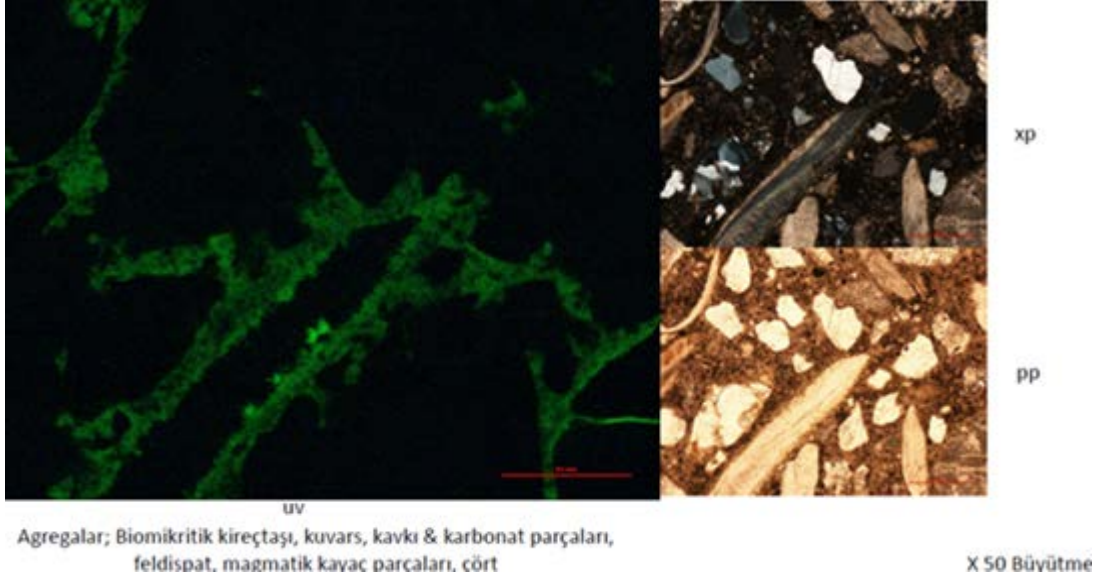
Şekil B.2 : Yalıtılmış ortamda etüv kürü uygulanan normal dayanımlı betonun iç yapısı (pp: tek nikol, xp: çift nikol, uv: ultraviyole ışık).
