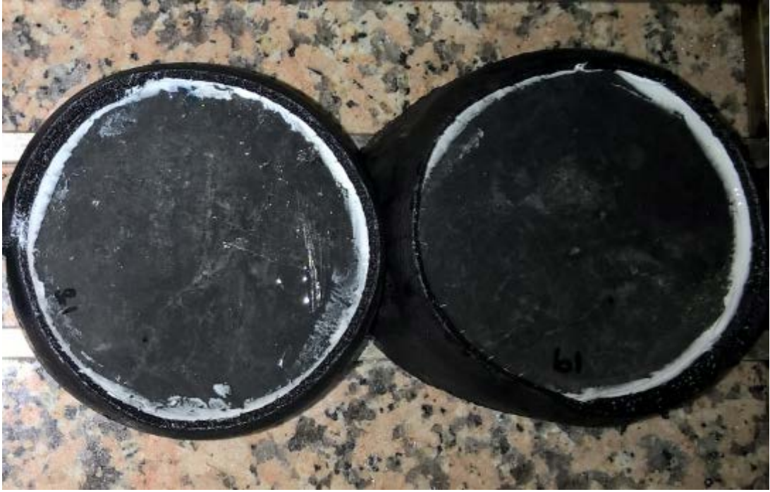
Şekil 4.51 : TM uygulanan ultra yüksek dayanımlı beton numunelerin donma çözülme çevrimleri sonrası görüntüsü.
