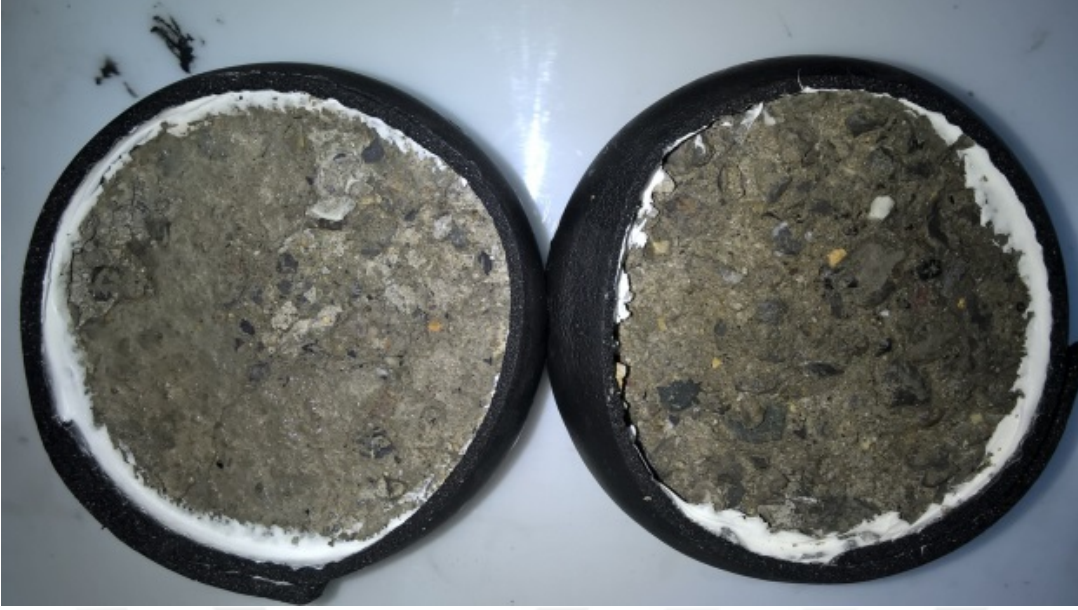
Şekil 4.48 : TM uygulanmayan normal dayanımlı beton numunelerin donma çözülme çevrimleri sonrası görüntüsü.
