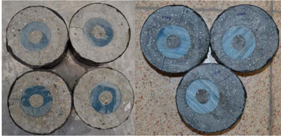
Şekil 4.25 : Plastik paspayı kullanılan normal (solda) ve ultra yüksek dayanımlı betonda (sağda) etüv kurusu numuneler.
