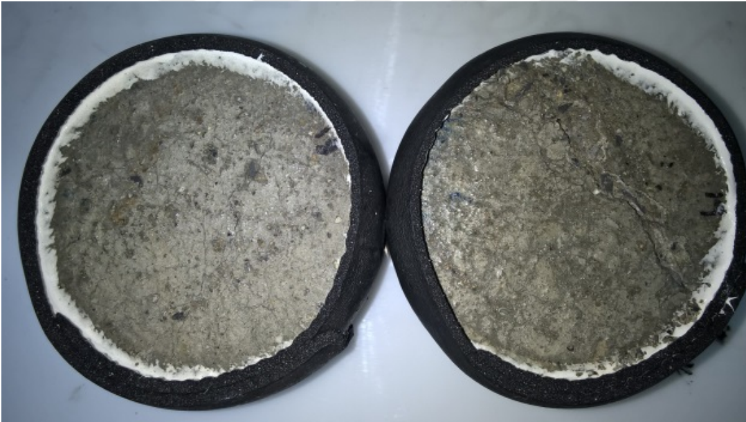
Şekil 4.49 : TM uygulanan normal dayanımlı beton numunelerin donma çözülme çevrimleri sonrası görüntüsü.
