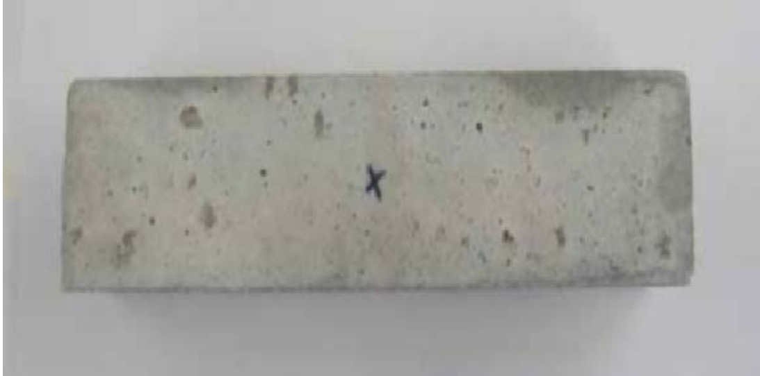
Şekil 2.11 : 95 hafta 1,06 molar NaCl çözeltisine maruz bırakılan numuneler [85].
