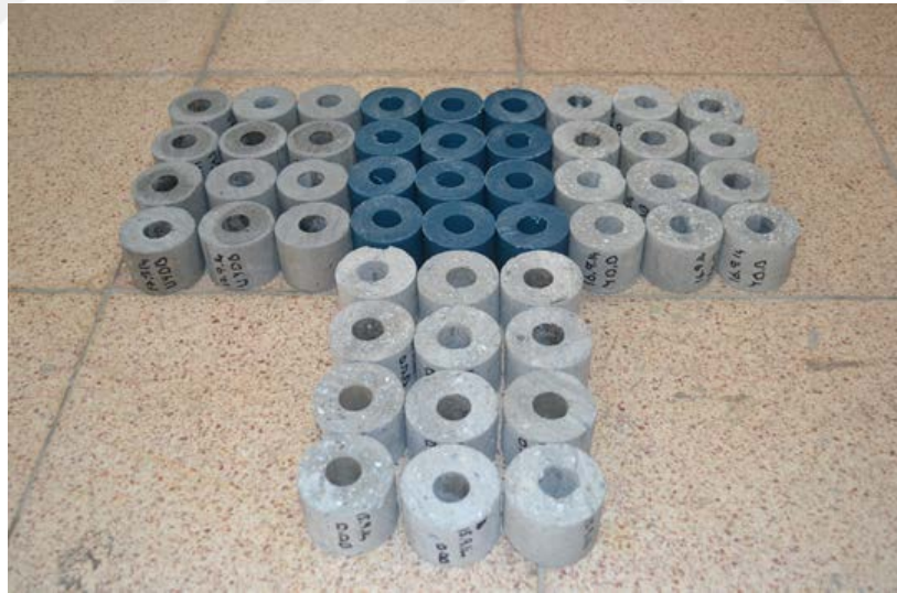
Şekil 4.23 : Aynı kesite sahip beton ve plastik paspayı numuneleri.
