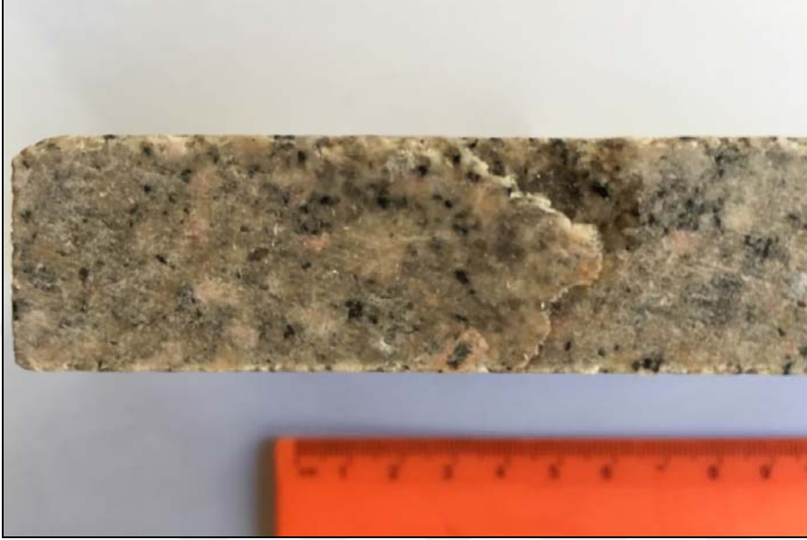
Şekil 5.60 : Termal şok deneyi sonrasında piritlerin oksidasyonu sonucunda oluşan sülfürik asit etkisiyle granit örneğindeki hasarların görünümü.
