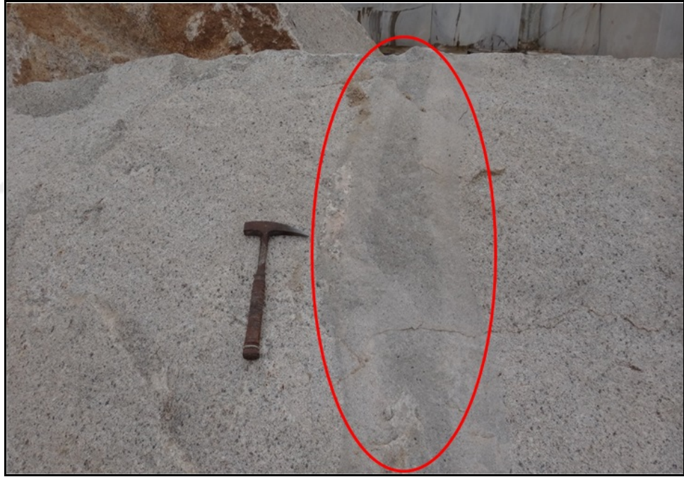
Şekil 4.36 : Üretilen granit blokları üzerinde gözlenen apolit damarları.
