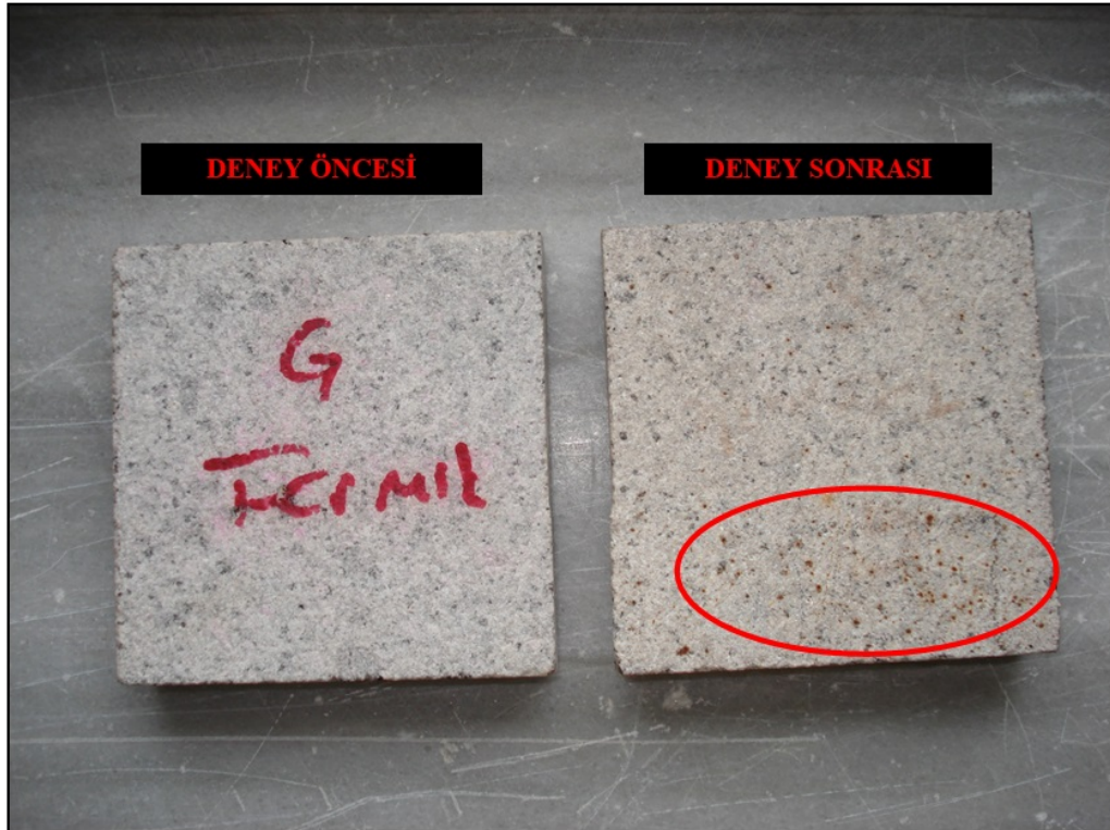
Şekil 5.59 : Termal şok deneyi sonrası gri renkli granit örneği üzerinde oluşan pas lekeleri.
