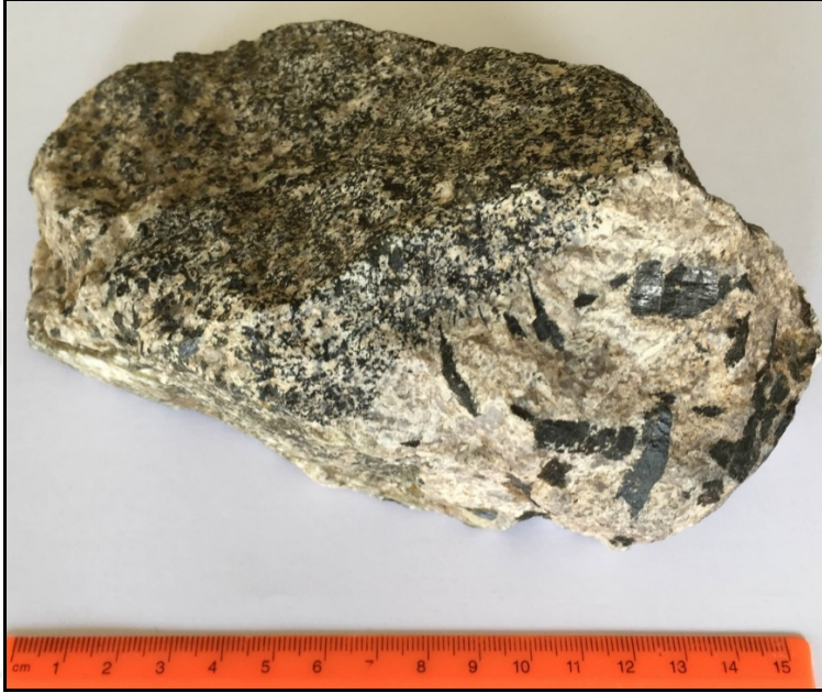
Şekil 4.18 : Prizmatik çubuksu hornblend mineralleri ile karakterize olan apinitin megaskobik görünümü.
