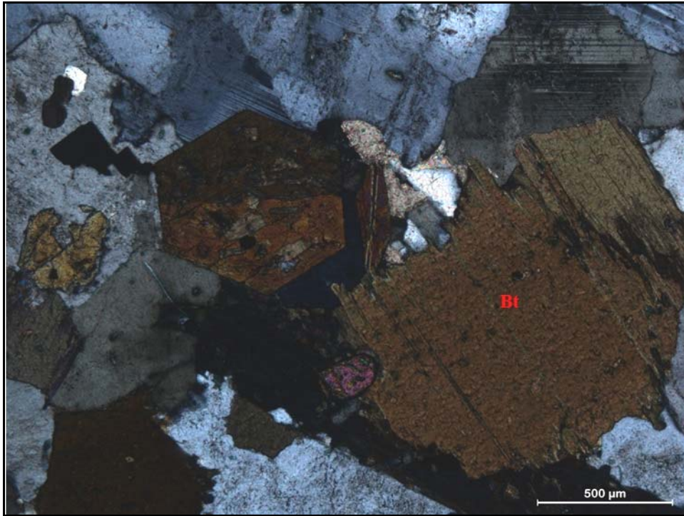
Şekil 5.46 : “Bergama Gri” granitindeki biyotitlerin polarizan mikroskop altındaki görüntüsü (ÇN, 10X; Bt: Biyotit).
