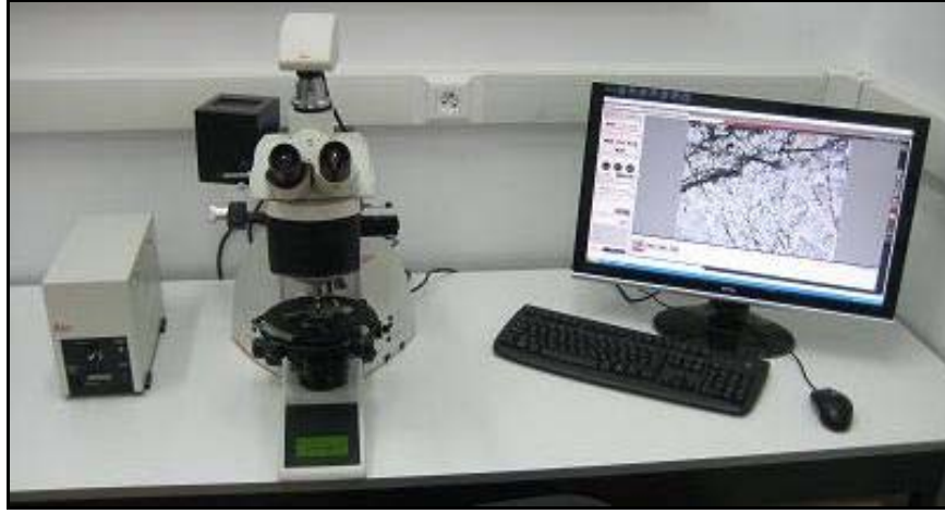
Şekil 2.1 : Leica DM4500P model polarizan petrografi mikroskobu.
