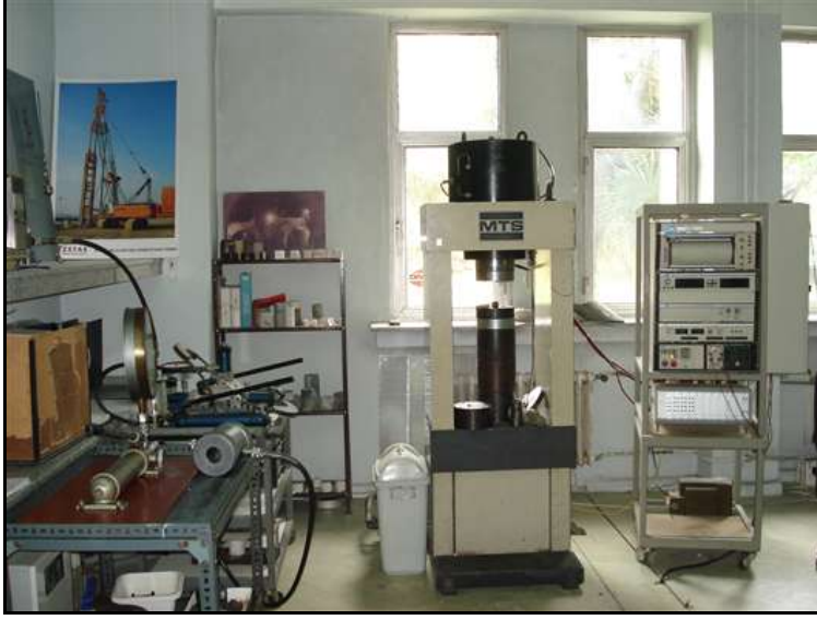
Şekil 2.10 : Mekanik laboratuvar deneylerinde kullanılan MTS marka pres cihazı.
