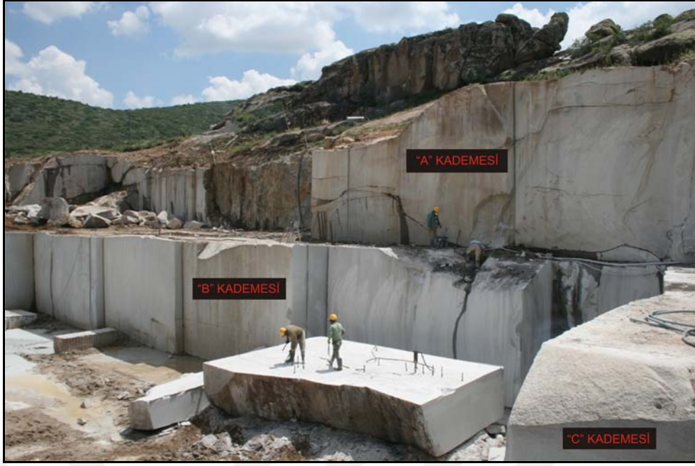
Şekil 4.4 : Granit blok taş ocağında üretim yapılan kademelerin görünümü.
