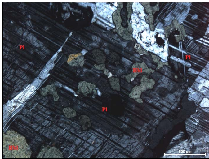
Şekil 5.20 : Mafik mikrogranüler anklav içindeki poyikilitik dokulu feldispat minerallerinin polarizan mikroskop altındaki görüntüsü (Çift Nikol, 5X; (Pl: Plajiyoklaz, Hbl: Hornblend).
