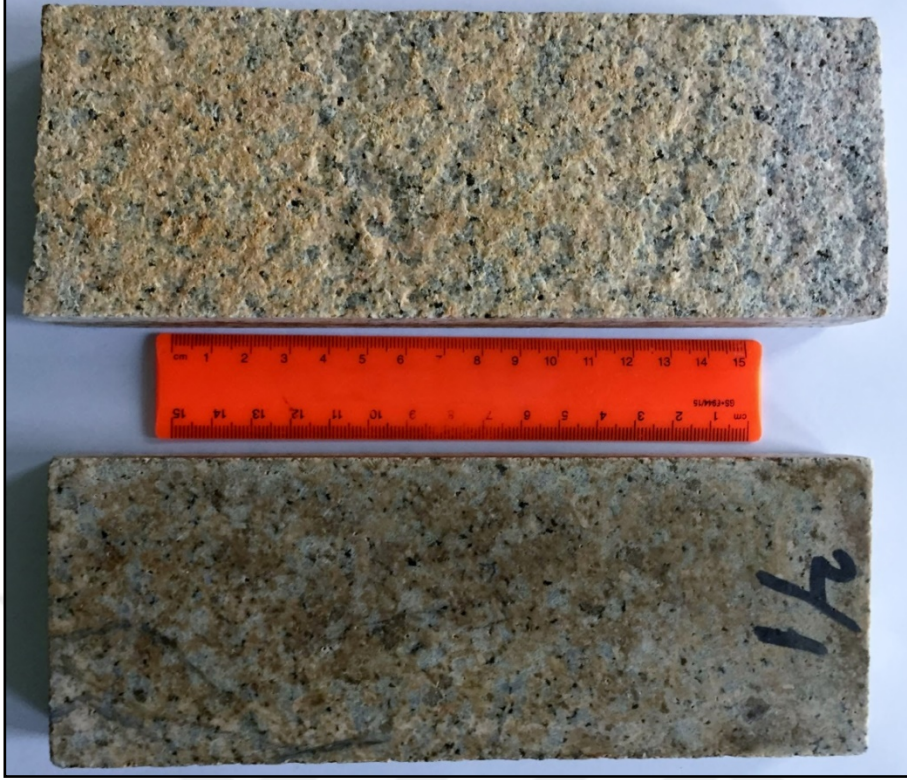
Şekil 5.65 : “Crema Lal” ticari isimli granit örneğinin üzerindeki pas lekelerinin tez çalışması kapsamında seçilen “poultice” karışımı ile temizlenme işlemi.
