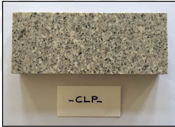
Şekil 4.43 : Açık pembe renkli “Crema Lal” ticari isimli granitin cilalı yüzeyinin megaskobik görünümü.
