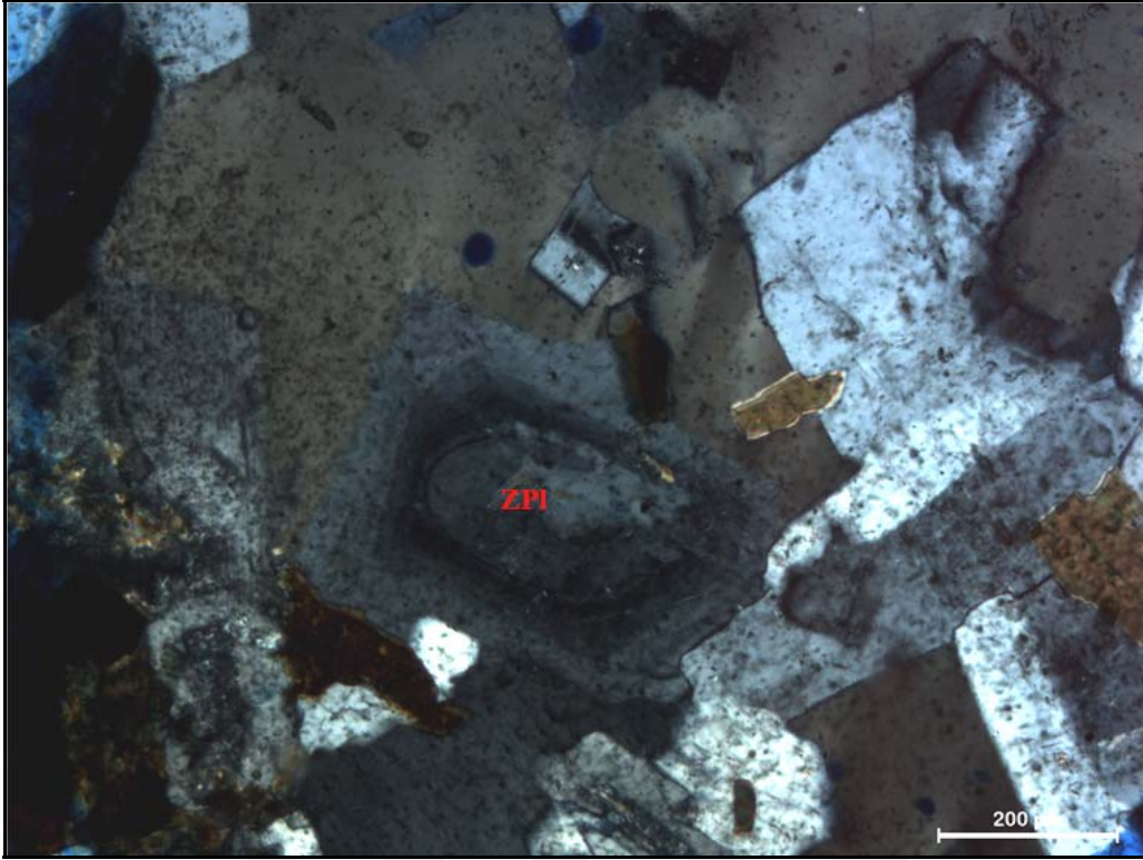
Şekil 5.21 : Ozancık Monzograniti içindeki zonlu plajiyoklaz mineralinin polarizan mikroskop altındaki görüntüsü (Çift Nikol, 10X; ZPl: Zonlu plajiyoklaz).
