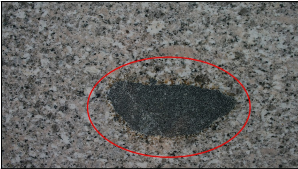
Şekil 4.31 : İşlenmiş granit plakası üzerinde gözlenen mafik mikrogranüler anklav.
