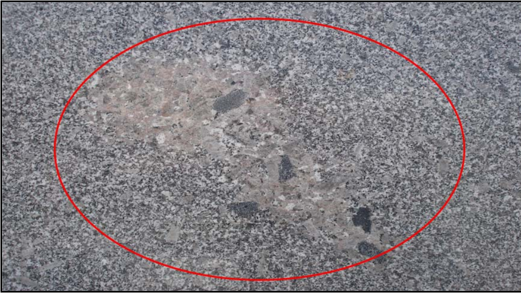
Şekil 4.38 : İşlenmiş granit plakası üzerinde gözlenen pegmatit cebi.
