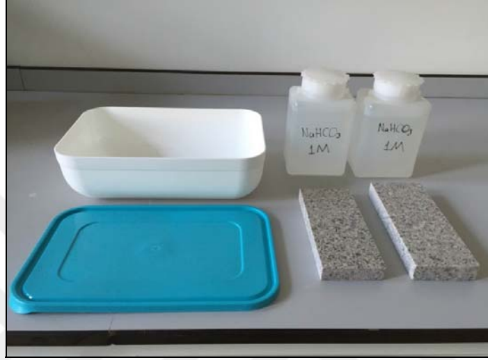
Şekil 5.61 : Alkali çözelti deneyi için hazırlanan 1M derişimli \text{NaHCO}_3 çözeltisi ve deney tabii tutulan gri renkli granit örnekleri.
