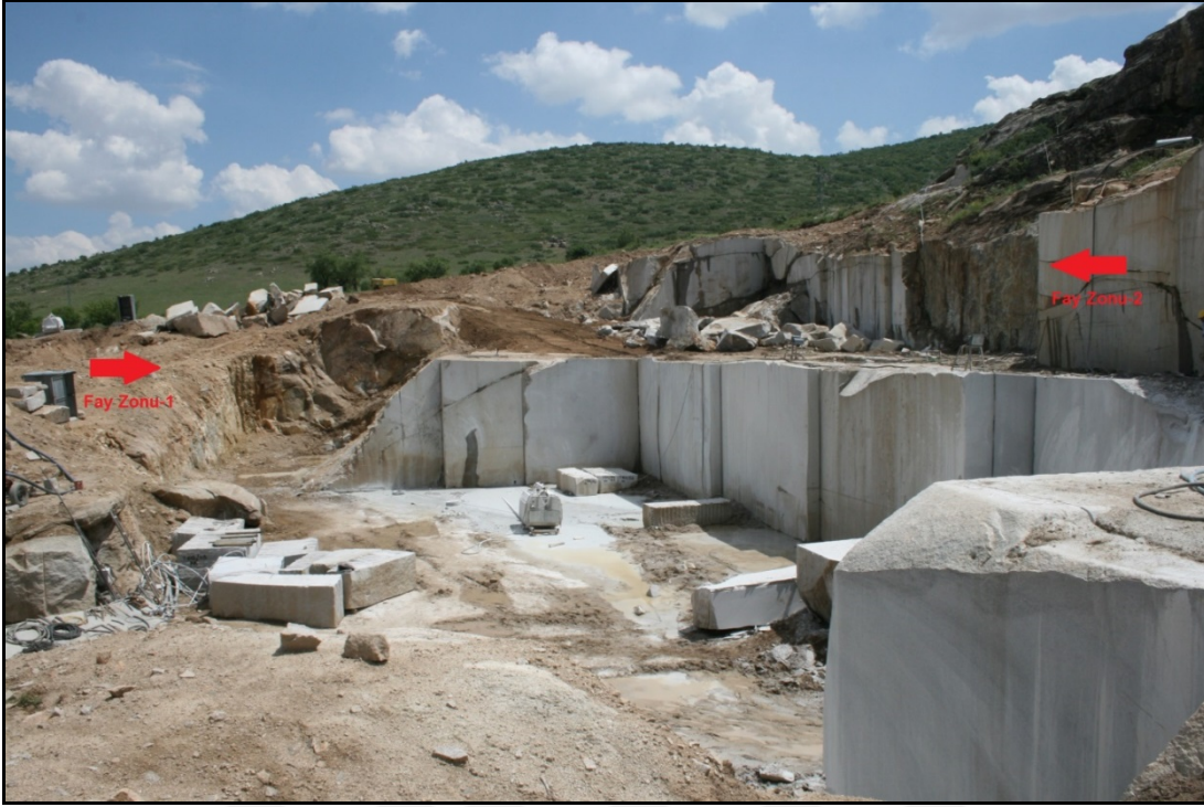
Şekil 4.28 : Ocağın üst ve alt kısmında bulunan ve üretimi sınırlayan ana fay zonlarının görünümü.
