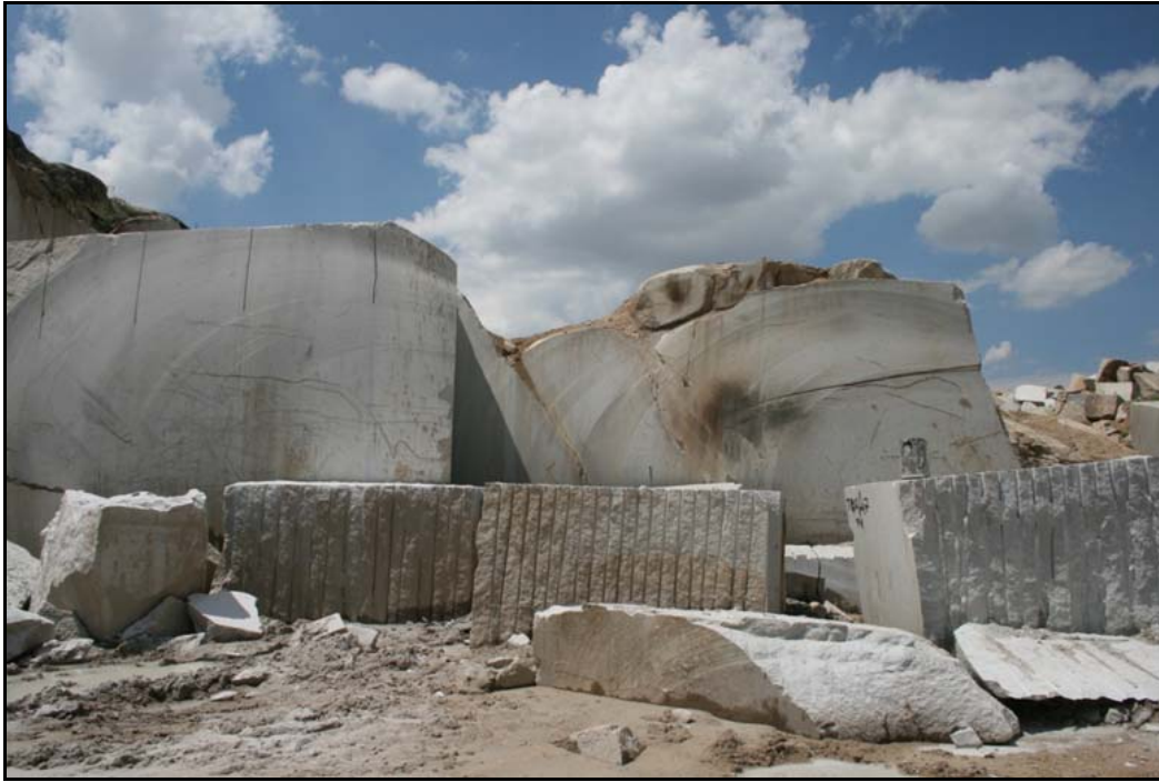
Şekil 5.16 : Ocağın “C” kademesindeki üretim aynasında yama şeklinde oluşan pas lekeleri.
