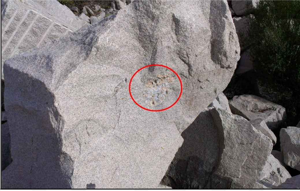
Şekil 4.37 : Üretilen granit bloklarında gözlenen pegmatit cebi.
