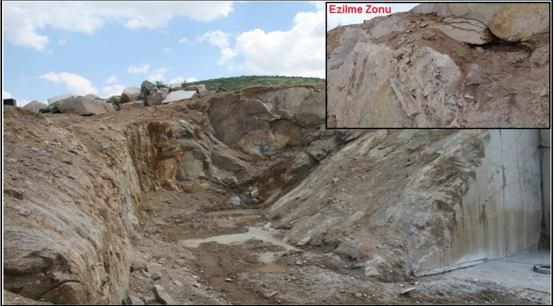
Şekil 4.27 : Ocakta bulunan ana fay ve ezilme (milonitik) zonunun görünümü.
