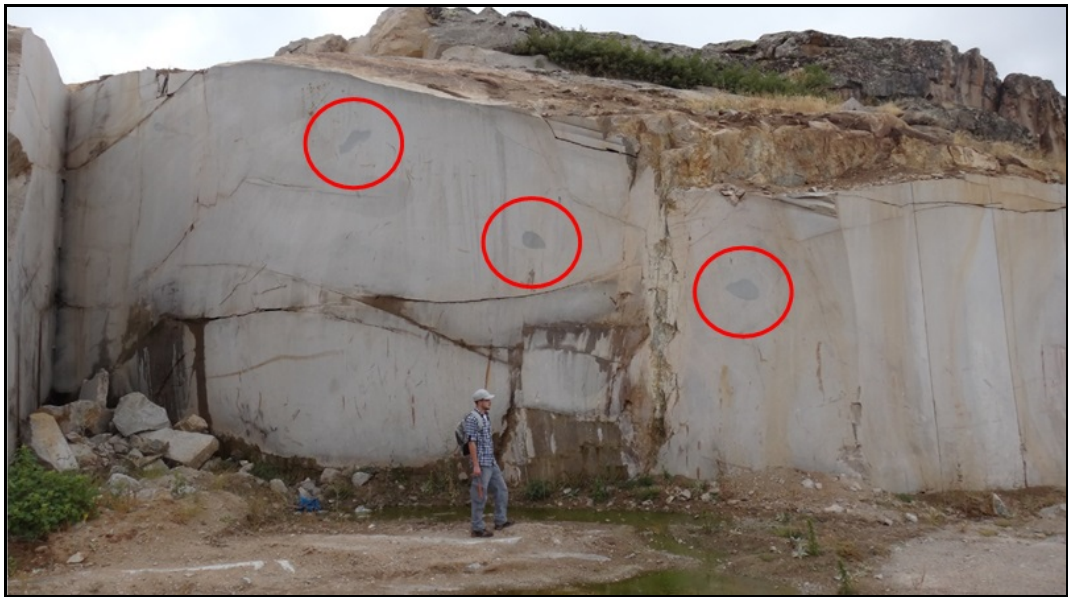
Şekil 4.29 : Ocak üretim kademelerinde gözlenen mafik mikrogranüler anklavlar.
