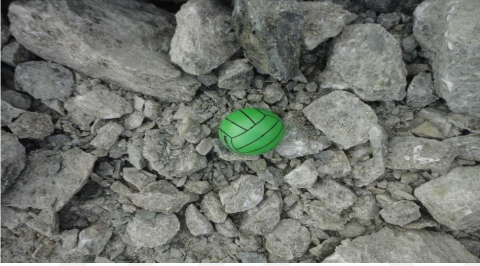
Şekil 5. 1 : Dikey olarak çekilen ölçekli fotoğraf.
