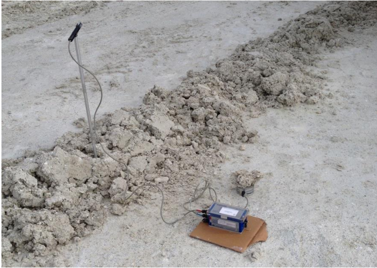
Şekil 6. 1 : MiniMate Plus Cihazı İle Arazi Ölçümü.
