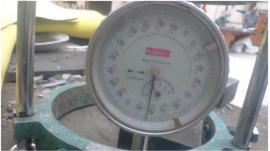
Şekil 3.6: Boyuna deformasyon ölçer ve çerçeve düzeneği.
