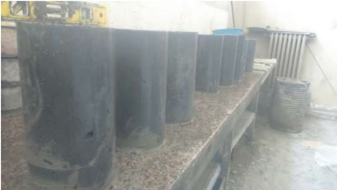
Şekil 3.4: Üretilen numunelere başlık imalatı yapılması.
