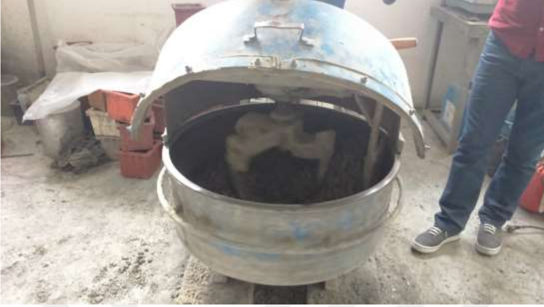
Şekil 3.2: Kuru Karışıma su ve katkının eklendiği mikser düzeneği.
