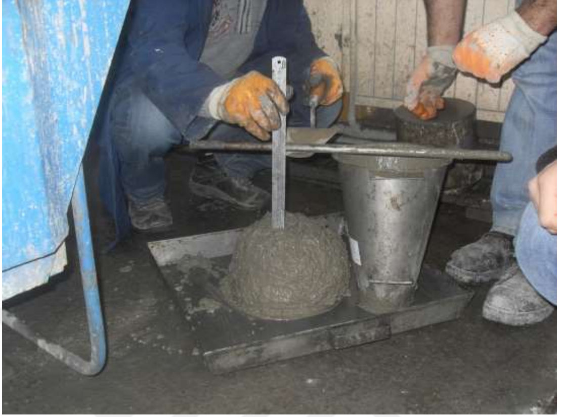
Şekil 3.3: Kıvam sınıfı belirlemek için çökme deneyleri.
