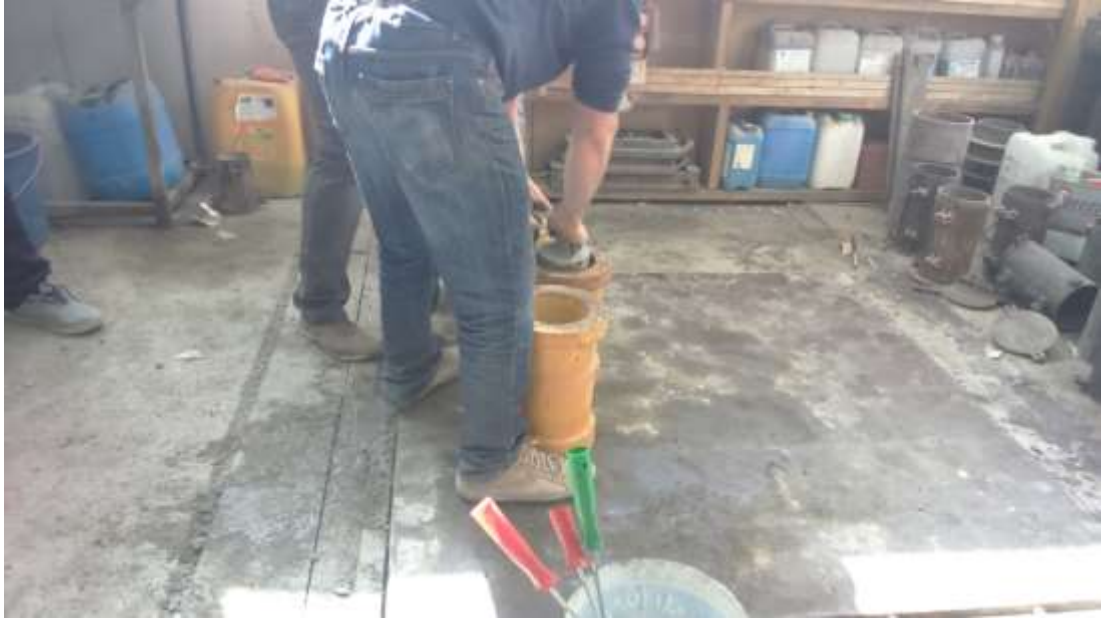
Şekil 3.1: Üretimi tamamlanan karışımların silindirik kaplara yerleştirilmesi, vibrasyon işlemi.
