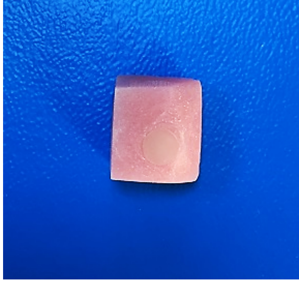
Şekil. 3.2.2. Deney grubu örnekleri üst yüzeyi açıkta kalacak şekilde gömülmüştür.
