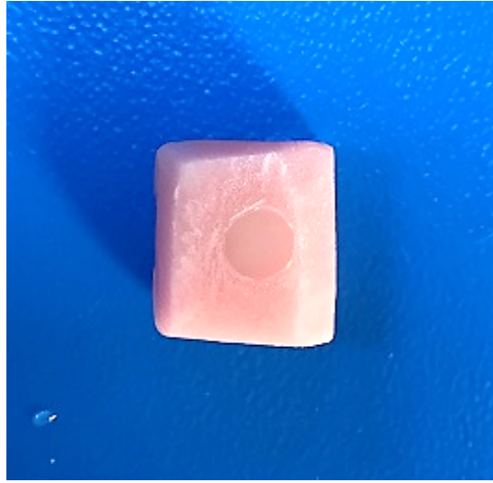
Şekil 3.2.5. Bitirme ve parlatma işlemi uygulanmış deney örnekleri.
