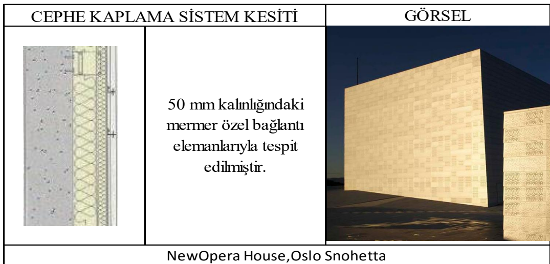
Şekil 3.33: MER 5A Cephe Kaplama Sistemi Detayı (The Plan Sayı 29).
