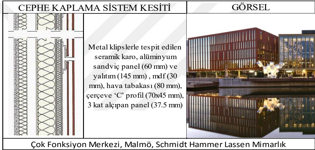
Şekil 3.29: POR 5A Cephe Kaplama Sistemi Detayı (The Plan: Sayı 90, 2016).
