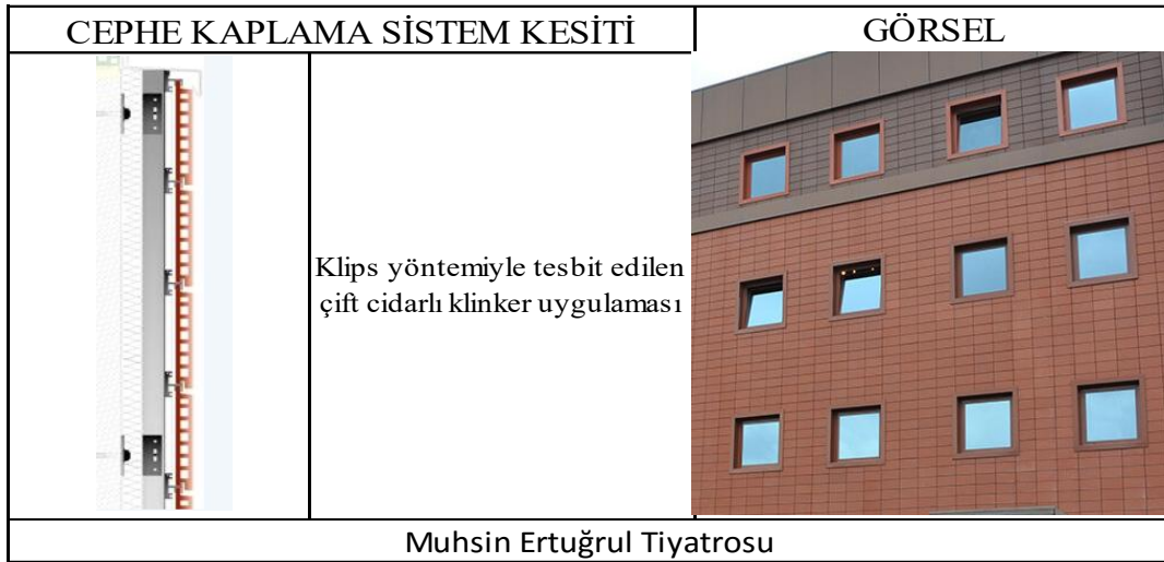
Şekil 3.25: KLİ 1A Cephe Kaplama Sistemi Detayı (Işıklar, 2016).
