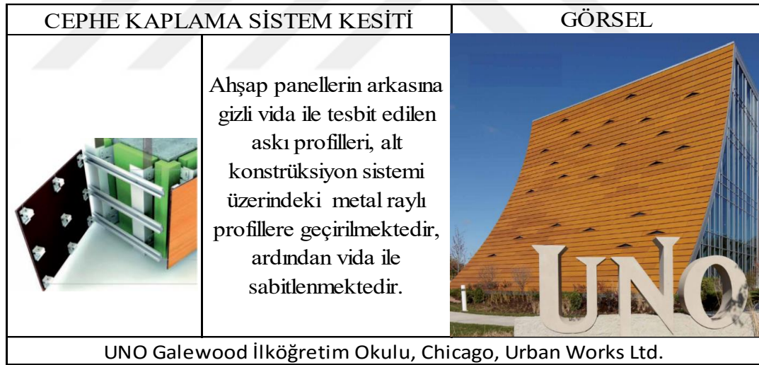
Şekil 3.41: KL 5A Cephe Kaplama Sistemi Detayı (Prodema).
