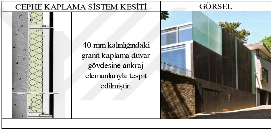
Şekil 3.32: GR 2B Cephe Kaplama Sistemi Detayı (The Plan Sayı 36, 2009).
