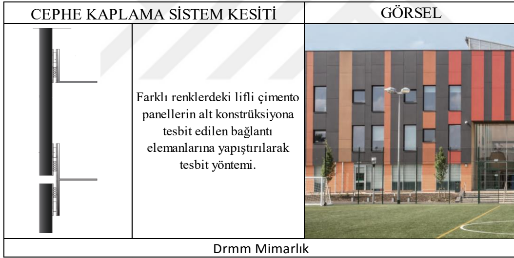
Şekil 3.34: LÇ 3C Cephe Kaplama Sistemi Detayı(Equitone katalog, 2013; Swiss pearl ® , 2016).
