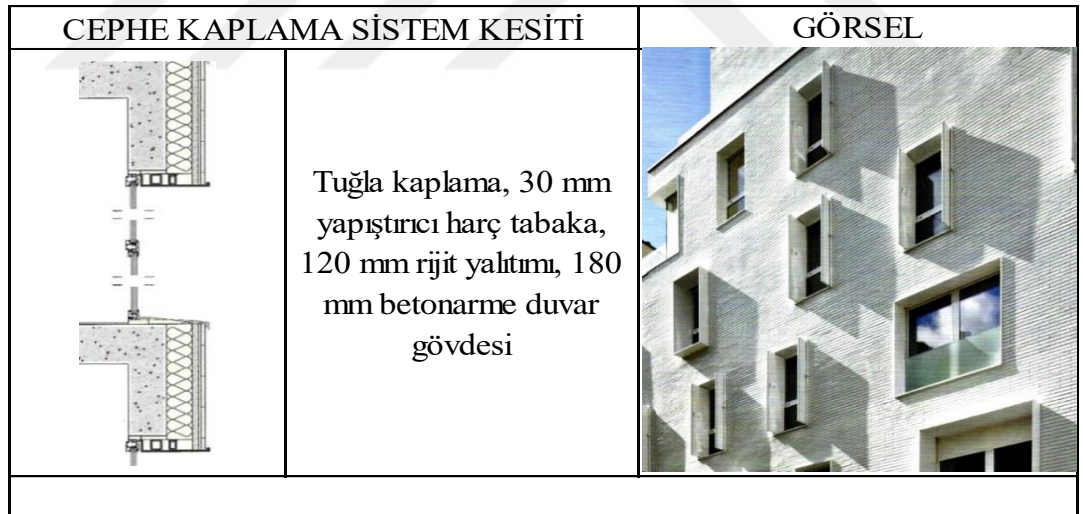
Şekil 3.24: TU 1A Cephe Kaplama Sistemi Detayı (Brookes, 2008).
