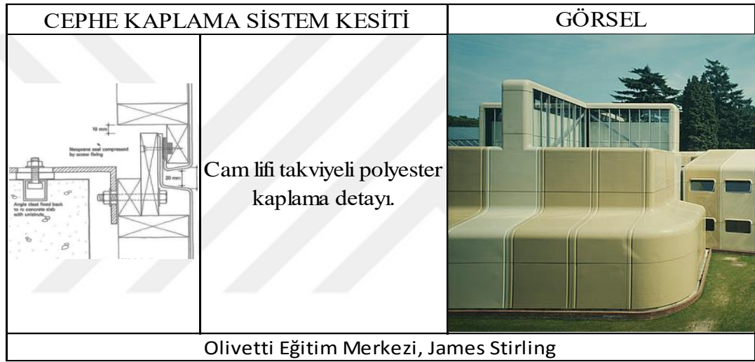
Şekil 3.23: CTP 2C Cephe Kaplama Sistemi Detayı (Brookes, 2008).
