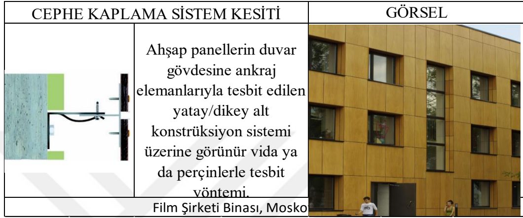
Şekil 3.40: KL 4A Cephe Kaplama Sistemi Detayı (Prodema).
