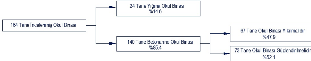
Şekil 4.20 : Van bölgesinde hasar gören yapıların istatistiksel incelemesi [57].
