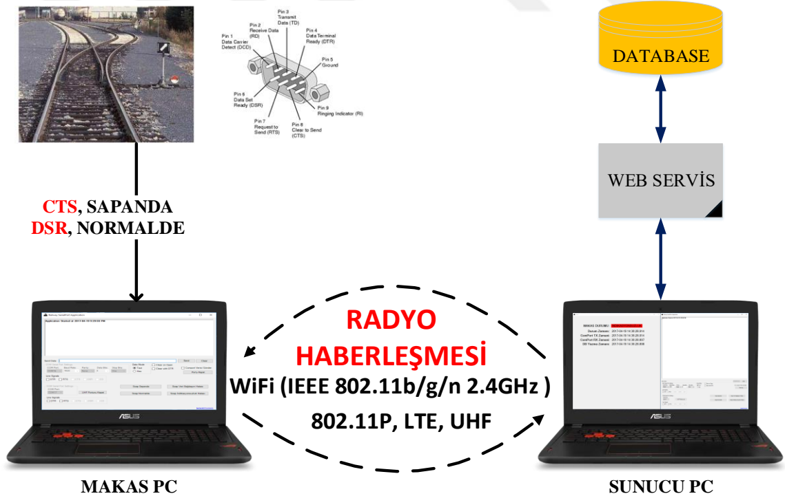
Şekil 8: Radyo haberleşmesi genel sistem diyagramı
