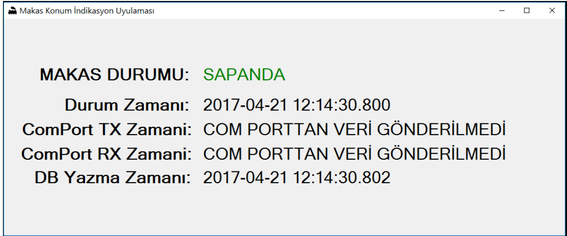
Şekil 18: Makas durumunu deęiřtięi anda ekranda gösteren uygulama
