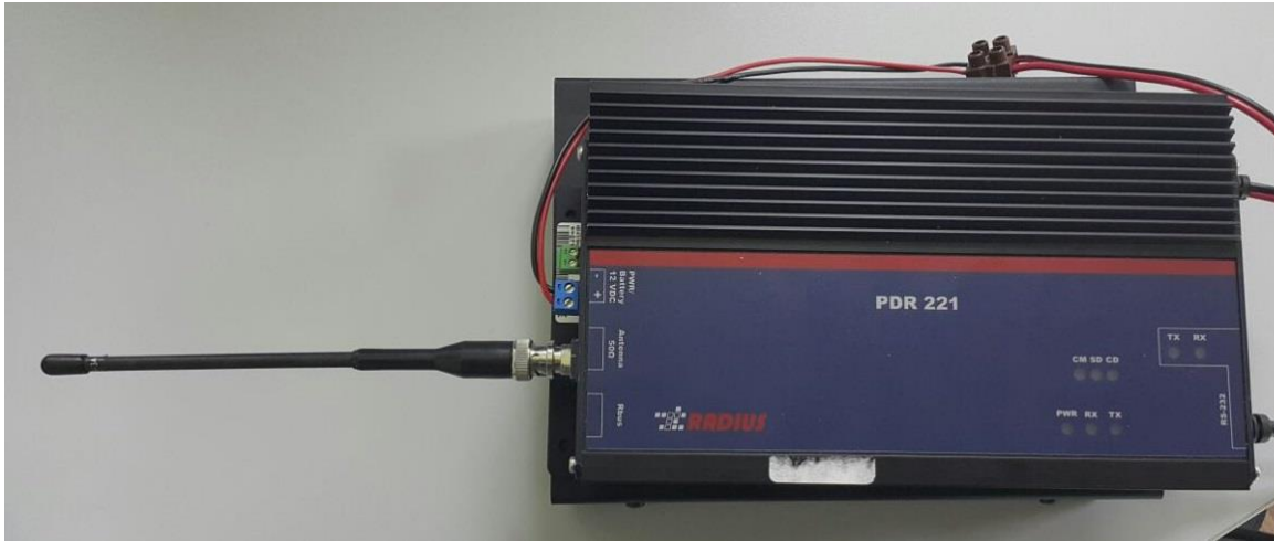
Şekil 50: RADIUS PDR 221, UHF radyo cihazı
