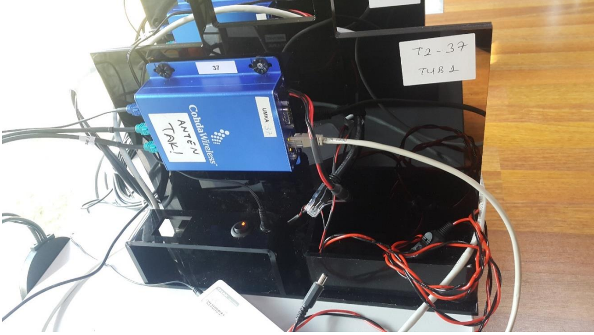
Şekil 64: Cohda Wireless MK5 802.11p cihazı
