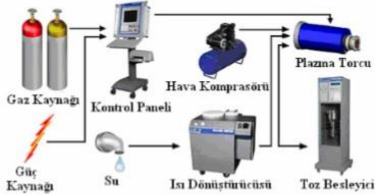
Şekil 2.13 : Atmosferik plazma sisteminin şematik gösterimi [28].
