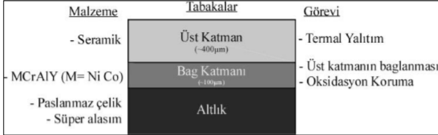
Şekil 2.9 : Termal bariyer kaplamaların şematik görünümü [17].
